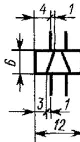
4. Катушка электромеханического устройства с одним отводом
