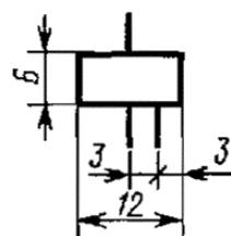
5. Катушка электромеханического устройства:
