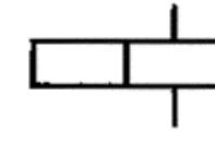
2. В дополнительном графическом поле указывают уточняющие данные электромеханического устройства, например, электромагнит переменного тока
