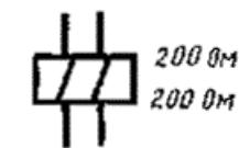
2. Если катушку электромеханического устройства с несколькими обмотками разносят на схеме, то каждую обмотку изображают следующим образом:
