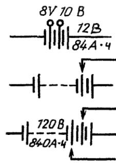
2. Условные графические обозначения электротермических источников должны соответствовать приведенным в табл. 2.
