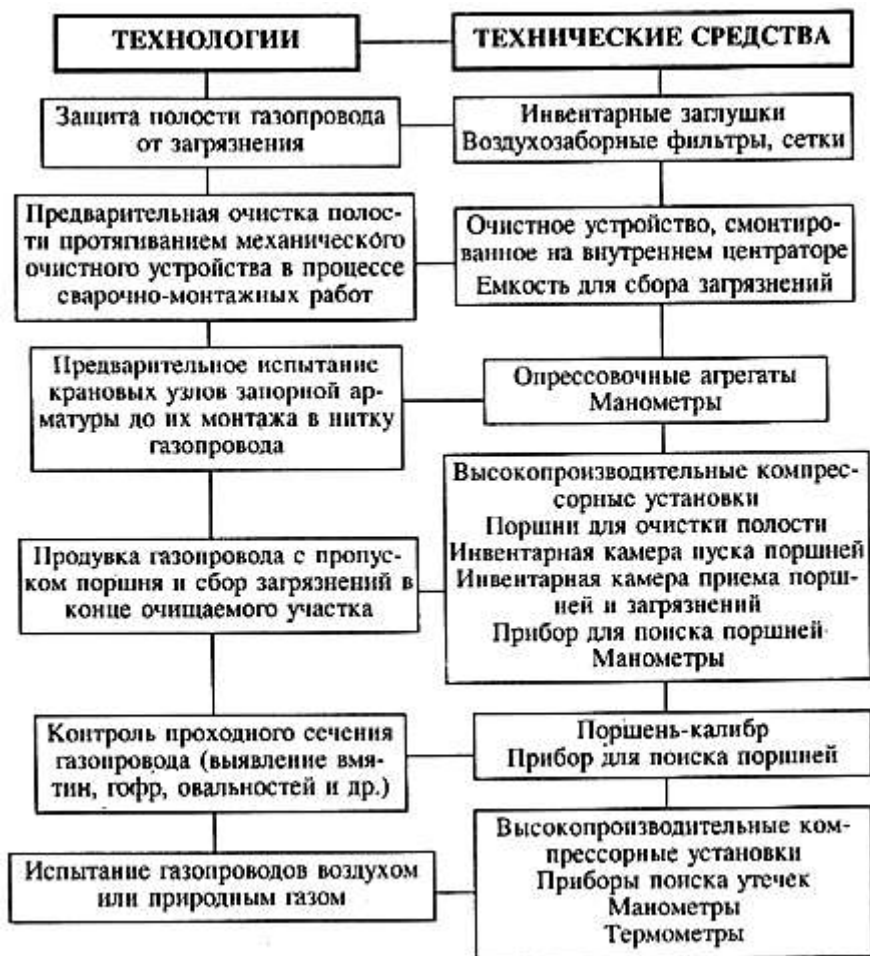
Рис.1. Технологии и технические средства по очистке полости и испытанию газопроводов пневматическим способом
