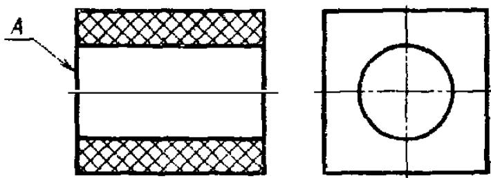
*Расположение слоев - параллельно поверхн. А*
