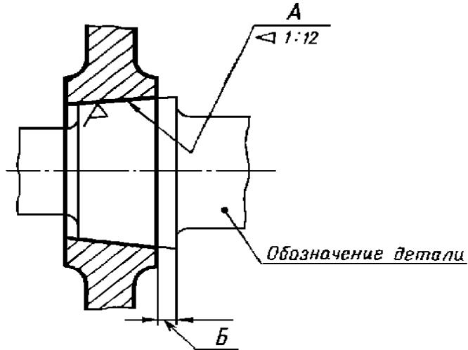
1. Поверхность А обработать по дет..., выдержав размер Б
