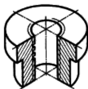
Рисунок А.3 — Изображение резьбы
