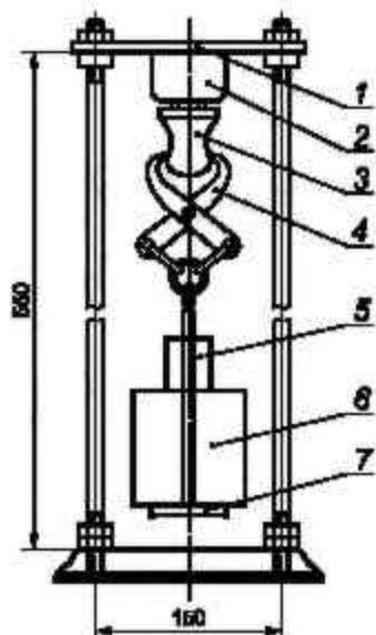
1 — держатель; 2 — образец; 3 — испытуемая вилка; 5 — захват; 6 — основной груз; 7 — опора
