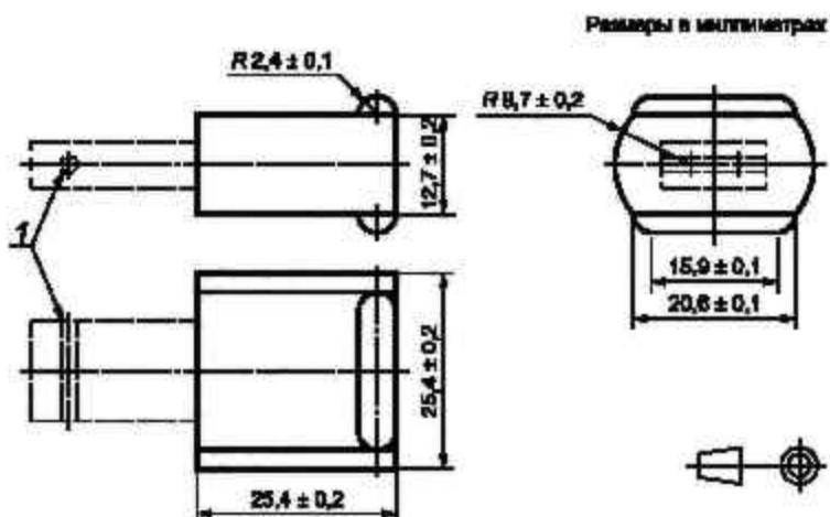
Материал: например, сталь горячей обработки.
