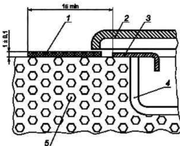
1 — лист жесткого материала; 2 — закрывающая пластина; 3 — воронная рама; 4 — монтажная пробка; 5 — стена
