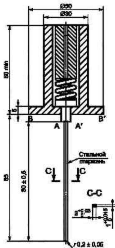
При калибровке прибора силу 20 Н прикладывают к наконечнику жесткого стального стержня вдоль его оси до совмещения плоскостей А-А' и В-В' за счет сжатия внутренней пружины.
