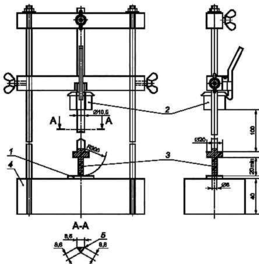
Рисунок 42 — Установка для испытания ударом при низкой температуре
