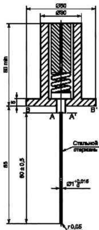
При калибровке прибора силу 1 Н присоединяют к нижней части жесткого стального стержня вдоль его оси до совмещения плоскостей А-А' и В-В' за счет скатия внутренней пружины.
