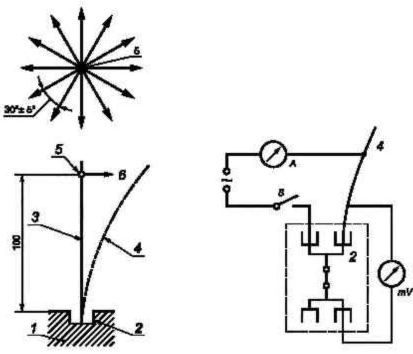
а) принцип действия испытательной установки для проверки на изгиб безвинтовых контактных зажимов
