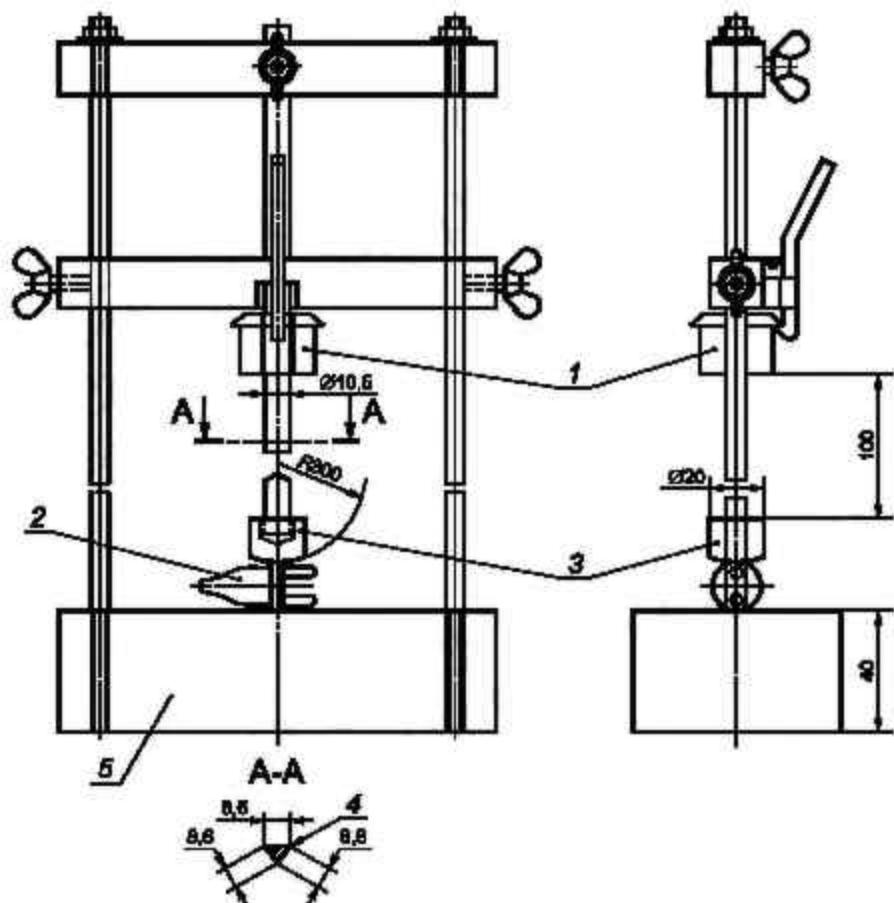
1 — боек массой  $(1000 \pm 2)$  кг; 2 — образец; 3 — прижим массой 100 г; 4 — кран закрутить, 5 — стальная опора  $(10 \pm 1)$  кг
