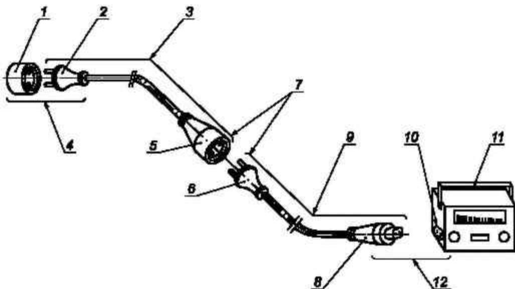
1 — розетка стационарная; 2 — вилка опрессованная; 3 — удлинитель одноместный; 4 — соединитель штепсельный;
