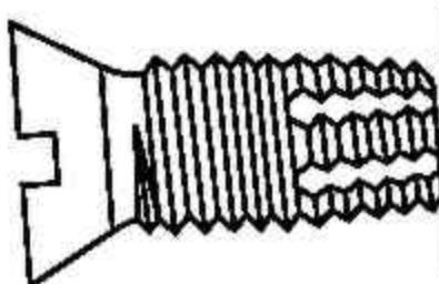
Рисунок 7 — Самонарезающий ронкующий винт
