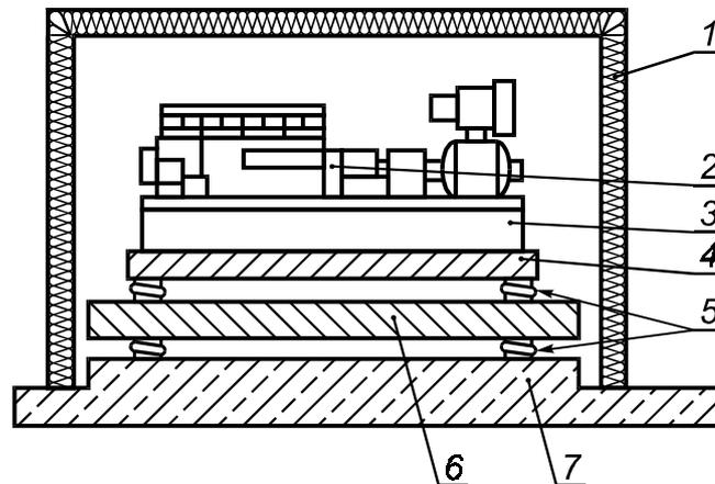
1 — кожух; 2 — источник шума и вибрации ( машина ); 3 — основание машины; 4 — тяжелая плита; 5 — упругие опоры; 6 — вторая плита; 7 — пол
