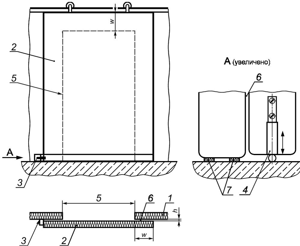
1 — стенка; 2 — сдвижная дверь; 3 — устройство, прижимающее уплотнитель двери к полу; 4 — опускающийся на пол уплотнитель двери; 5 — дверной проем; 6 — щель между полотном двери и стенкой [ $h$  — ширина щели (обычно  $h = 10$  мм),  $w$  — перекрытие дверью проема ( $w \geq 20 h$ )]; 7 — резиновое уплотнение
