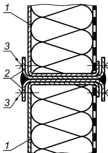
1 — стенка; 2 — сваренные U-образные профили; 3 — винтовое соединение
