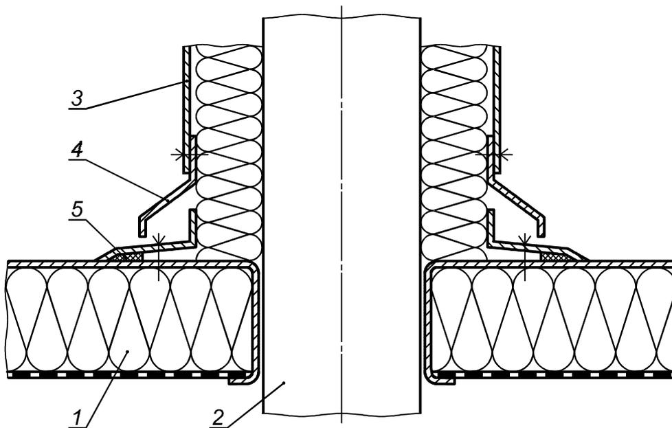
1 — потолочная панель; 2 — выхлопная труба; 3 — облицовка теплоизоляции; 4 — колпак; 5 — резиновое уплотнение
