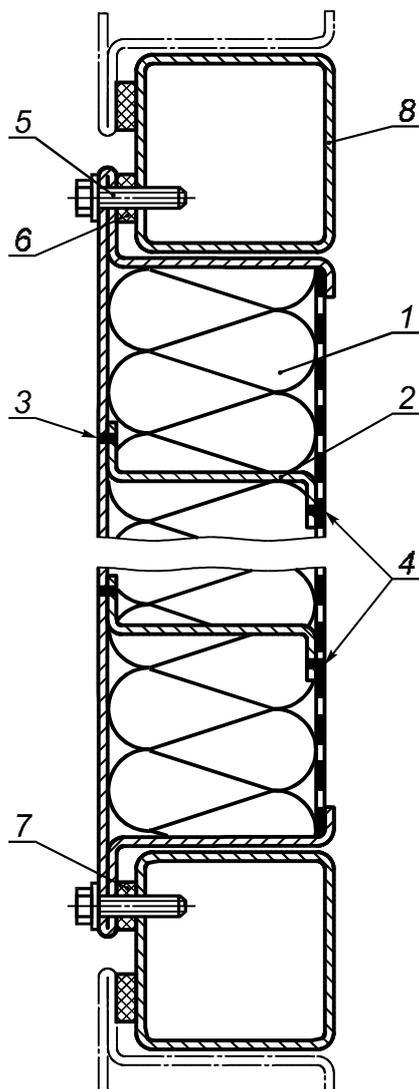
1 — съемная панель; 2 — ребро жесткости; 3 — точка сварки с внешней облицовкой; 4 — точка сварки на перфорированной облицовке; 5 — винт; 6 — самоклеящееся резиновое уплотнение с отверстиями; 7 — резиновый уплотнитель (как альтернатива детали 6); 8 — каркас кожуха
