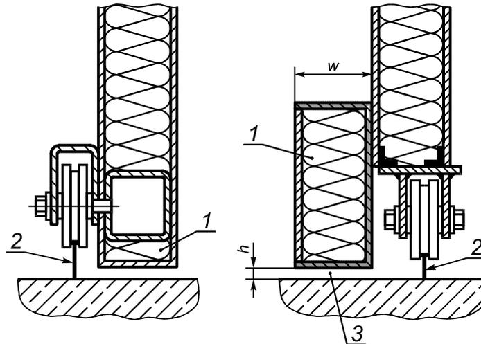
1 — выступ, заполненный звукопоглощающим материалом; 2 — рельс; 3 — щель шириной  $h$  и длиной  $w \geq 20h$
