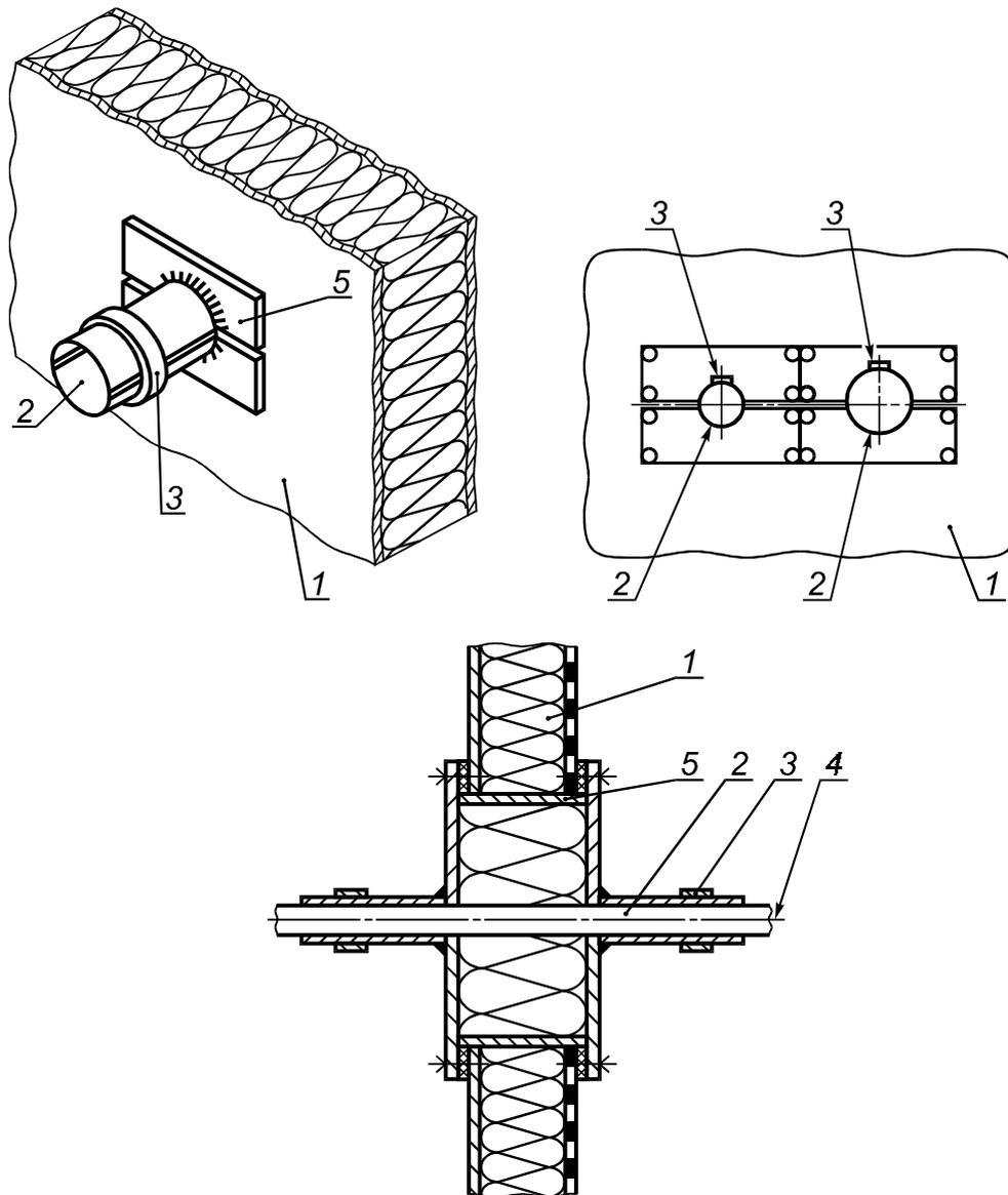
1 — стенка; 2 — половинки труб (продольно разрезанные трубы), приваренные к пластине; 3 — хомут; 4 — кабель;
