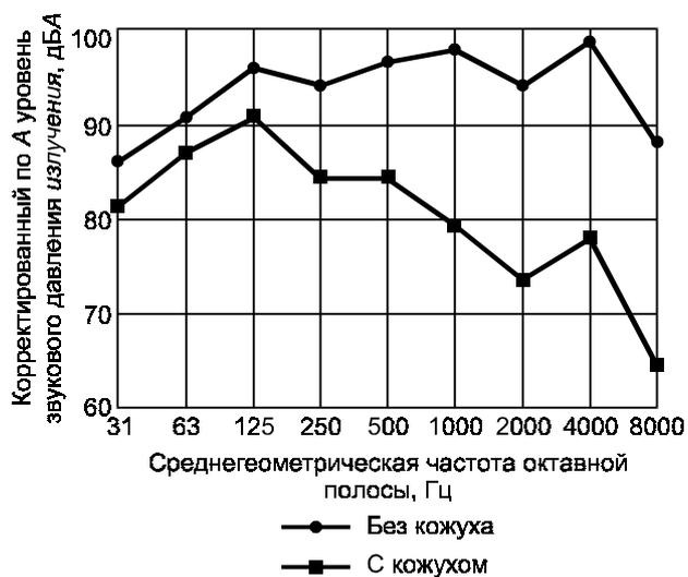
**Примечание** — Данные получены при измерениях на расстоянии 1 м от турбины до установки кожуха и на расстоянии 1 м от стенки кожуха после его установки.
