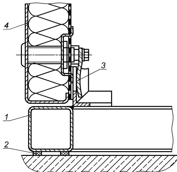
1 — каркас основания; 2 — резиновое уплотнение; 3 — прикрепляемый винтами угловой зажим; 4 — стенка
