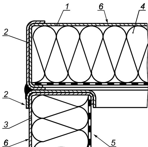
1 — потолочная панель; 2 — сваренные U-образные профили; 3 — стенка; 4 — звукопоглощающий материал; 5 — перфорированная облицовка; 6 — наружная обшивка
