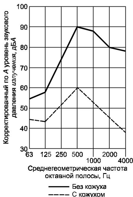
Рисунок 3 — Типичный пример скорректированных по А октавных уровней звукового давления *излучения* до и после установки кожуха
