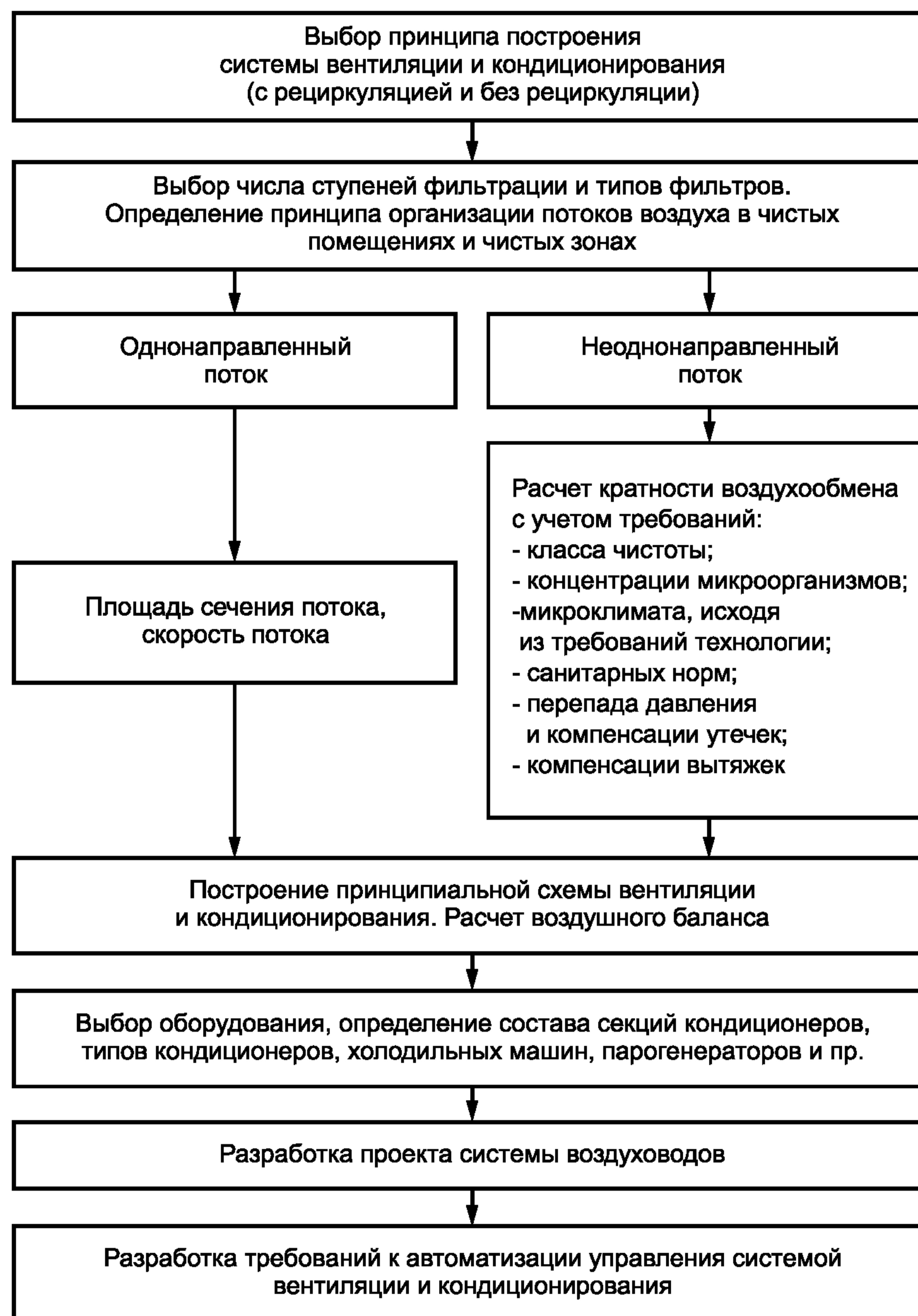
Рисунок В.2 — Последовательность разработки проектных решений по вентиляции и кондиционированию
