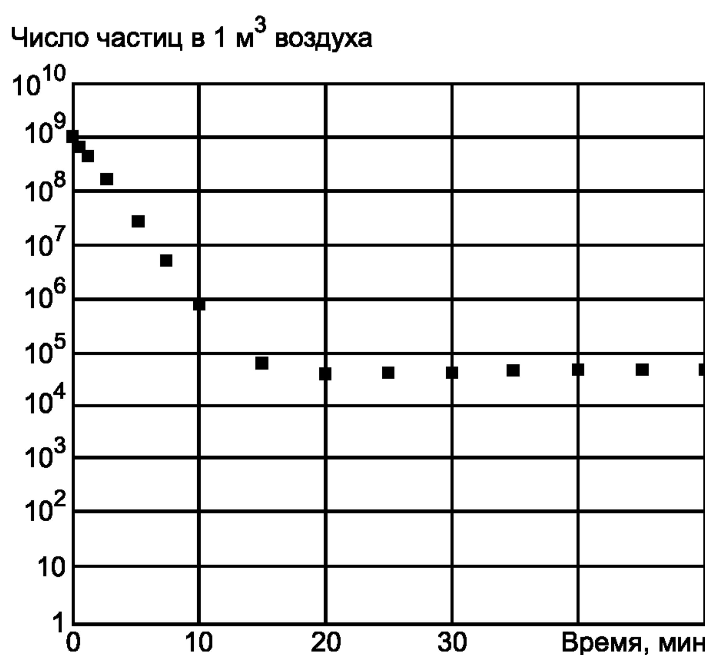
Рисунок С.1 — Зависимость концентрации частиц от времени после пуска чистого помещения
