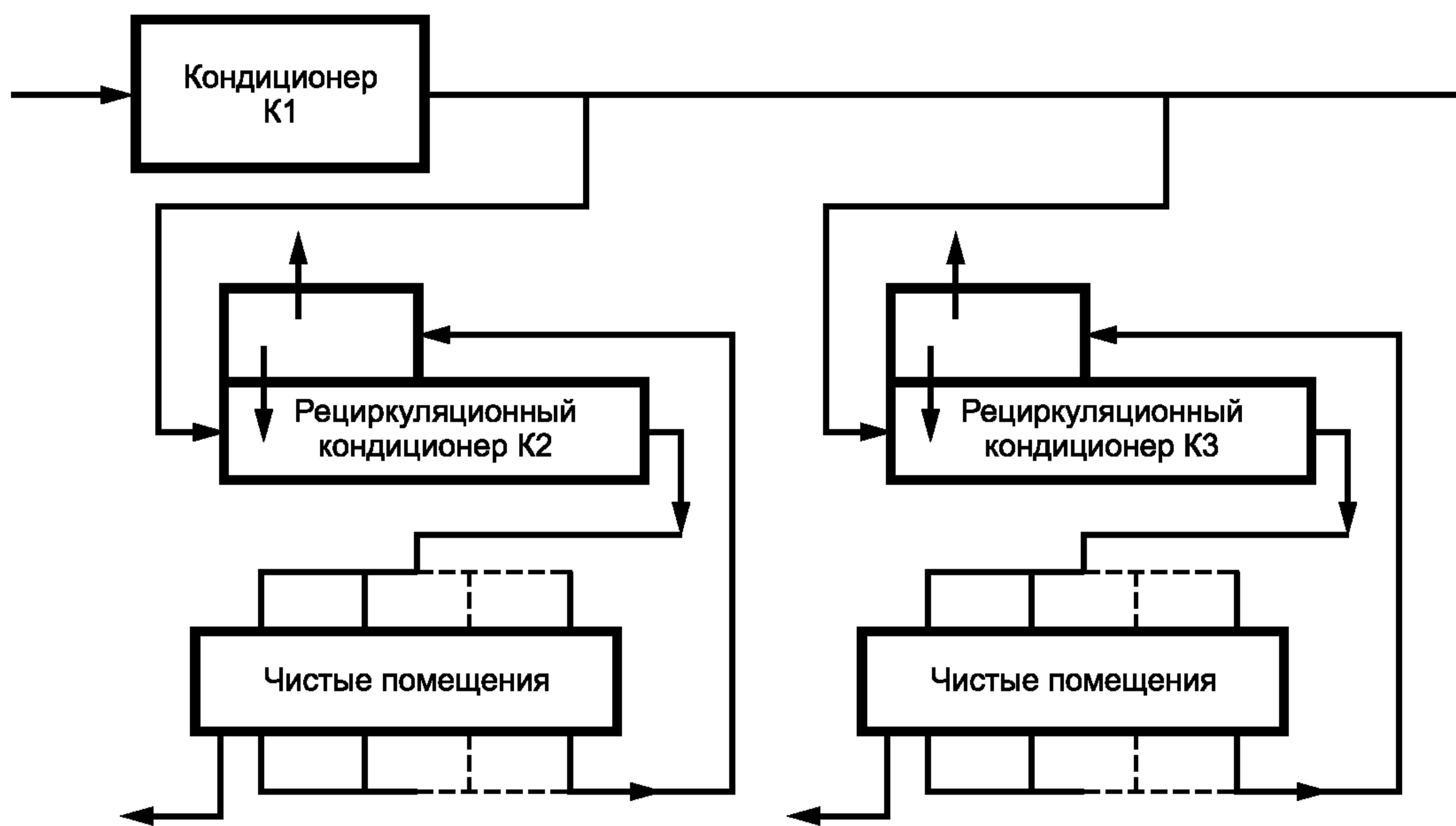
Рисунок А.4 — Двухуровневая система вентиляции и кондиционирования
