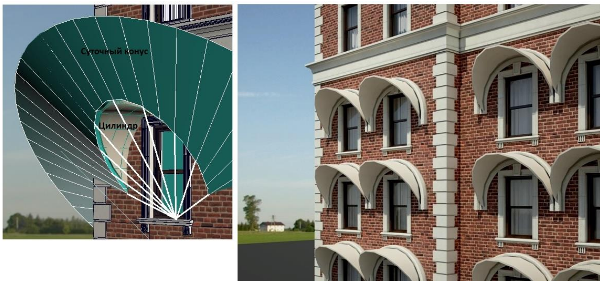
Рисунок 8.12 – Фасад с солнцезащитными кожухами
