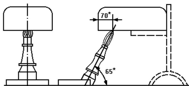
*Рис. 2. Расположение горелки при горизонтальном расположении образца*
