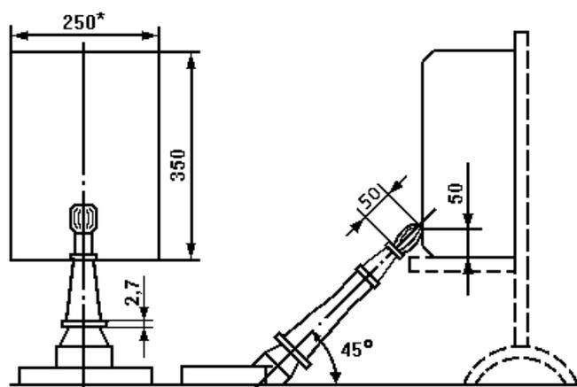
*Рис. 1. Расположение горелки при вертикальном расположении образца*
