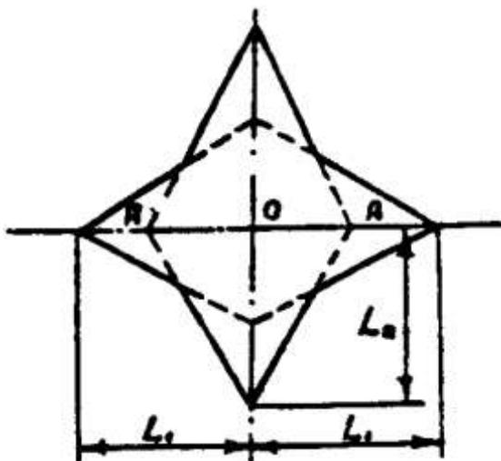
**Схема обеспечения видимости на пересечениях и примыканиях**
