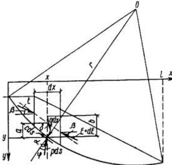
Схема сил, действующих на элемент призмы обрушения
