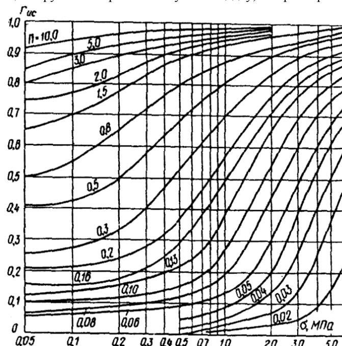
Черт. 1. Номограмма для определения коэффициента парового давления  $r_{uc}$
