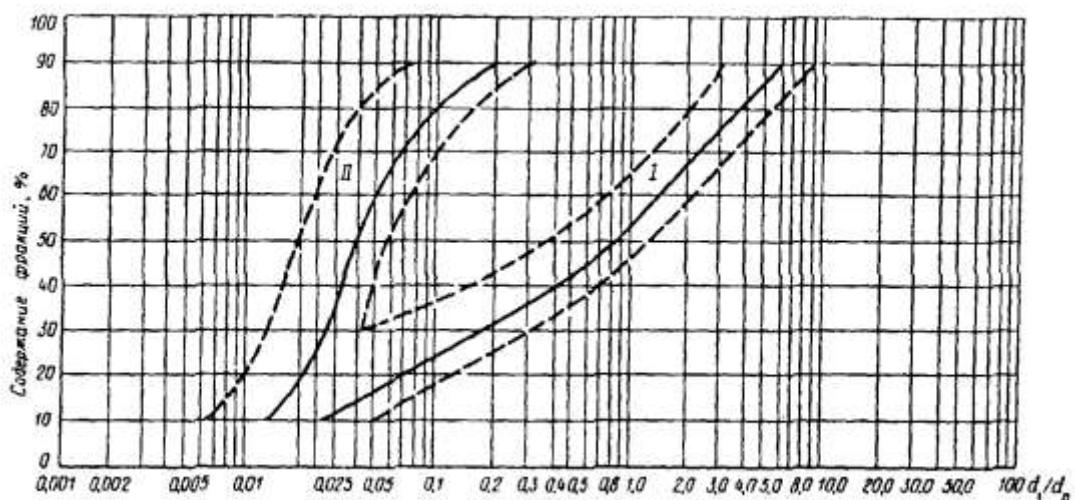
Черт. 3. График зависимости  $\alpha = f\left(\frac{d_i}{d_0}\right)$ . Неоднородные плотины из крупного песчано-гравийного грунта с центральной песчаной зоной
