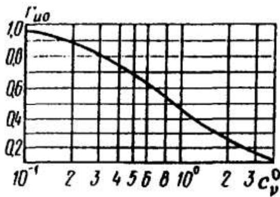
Черт. 3. График зависимости коэффициента порового давления  $r_{u0}$  от  $c_v^0$
