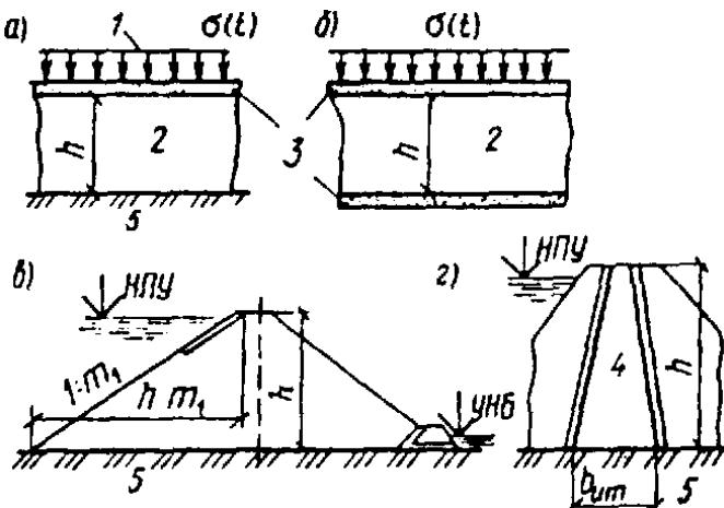
**Черт. 4. Различные случаи определения коэффициента порового давления  $r_{u0}$**
