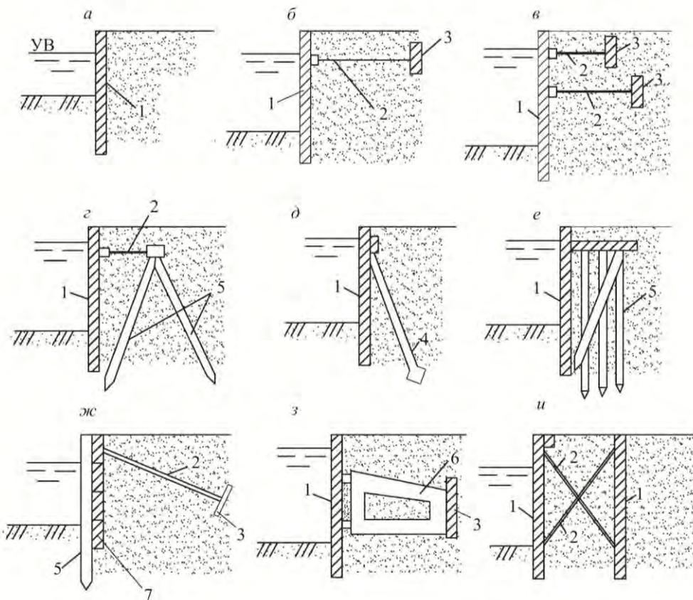
*а – безанкерные; б, в, г – заанкеренные одной или двумя тягами к плитам и сваям; д – заанкеренные к наклонным сваям; е – свайный ростверк с передним шпунтом; жс – забирчатого типа; з – заанкеренные с жестким (в том числе скользящим) анкерным устройством; и – в виде взаимозаанкеренных шпунтовых стен;*
