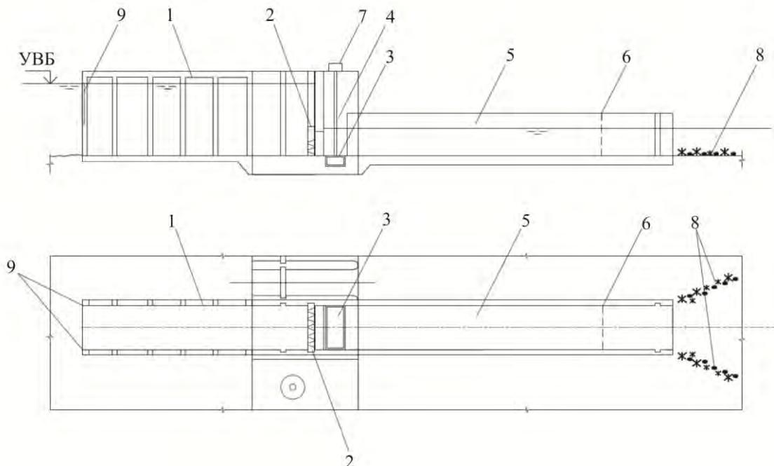
1 – верховой (выходной) лоток; 2 – затвор эксплуатационный с блоком питания; 3 – контейнер (кубель); 4 – рабочая камера; 5 – рыбонакопитель; 6 – побудительное устройство; 7 – механизм для подъема и перемещения контейнера; 8 – рыбонаправляющие устройства; 9 – счетное устройство
