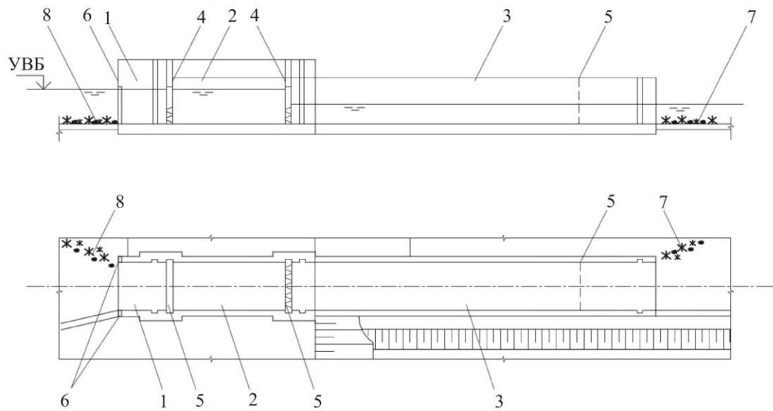
1 – верховой (выходной) лоток; 2 – аварийно-ремонтные заграждения; 3 – побудительное устройство; 4 – рыбонакопитель; 5 – затворы эксплуатационные с блоком питания; 6 – рабочая камера; 7 – счетное устройство
