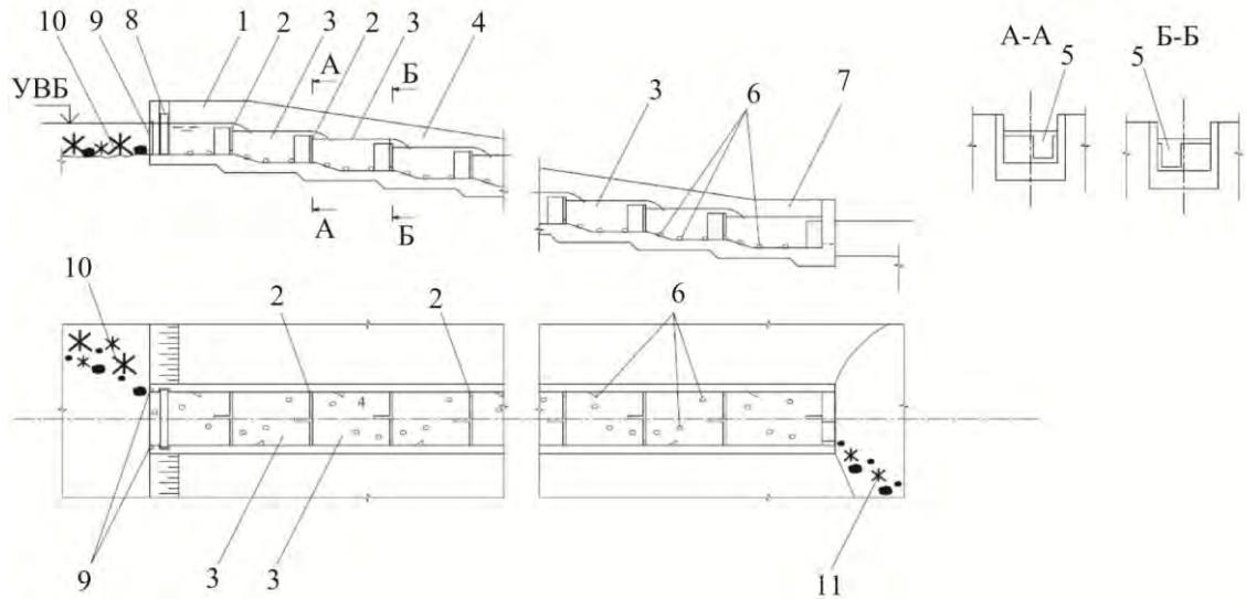
1 – верхняя голова; 2 – разделительная стенка; 3 – камеры тракта; 4 – тракт; 5 – вплывные отверстия; 6 – элементы искусственной шероховатости; 7 – входной оголовок; 8 – устройство для регулирования расхода; 9 – счетное устройство; 10 – искусственные ориентиры; 11 – рыбонаправляющие устройства
