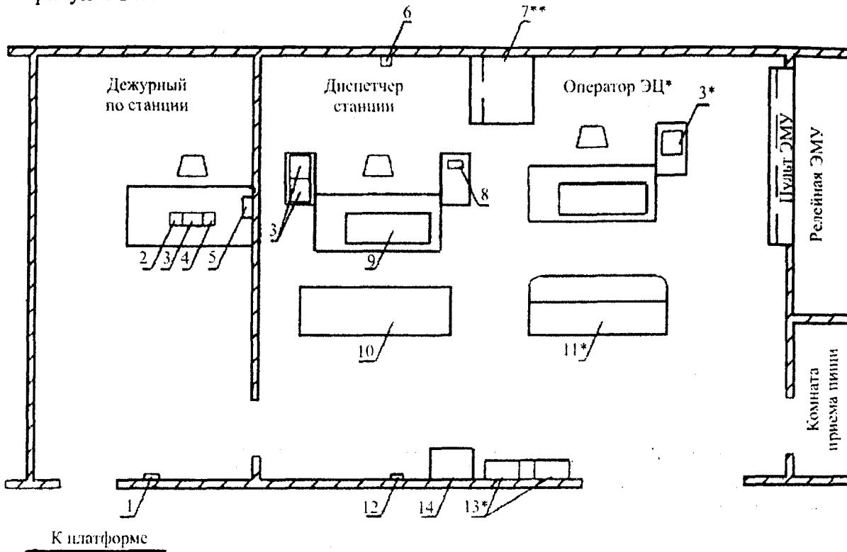
**Рисунок В.1 – Схема расположения оборудования в помещениях ДПС станции с путевым развитием**
