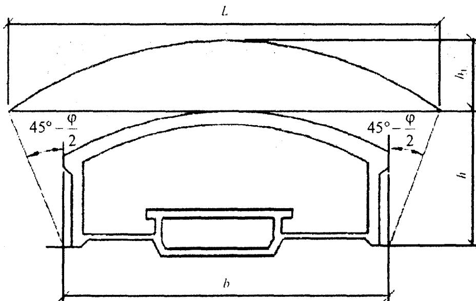
Рисунок 5.1 – Схема для расчета высоты свода обрушения
