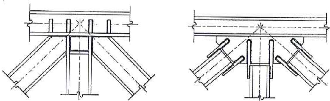
Рисунок Б.2 – Примеры выполнения узлов аутригерных ферм
