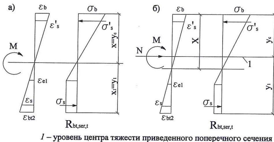
Рисунок 8.1 – Схема напряженно-деформированного состояния сечения элемента при проверке образования трещин при действии изгибающего момента (а), изгибающего момента и продольной силы (б)
