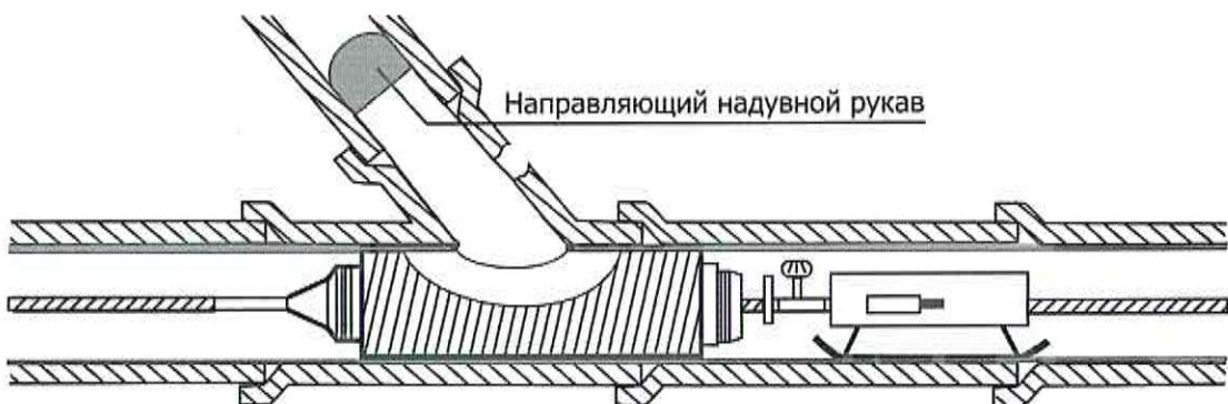
Этап 2. Позиционирование и затвердевание шляпообразной вставки.
