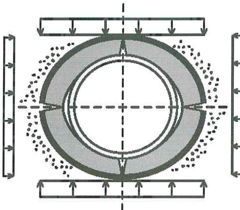
Рисунок 4 — Система «старая труба – грунт». Класс состояния 3
