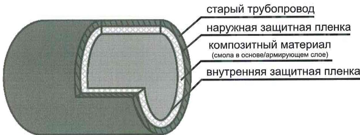
Рисунок 1 – Типовая конструкция гибкого полимерного рукава
