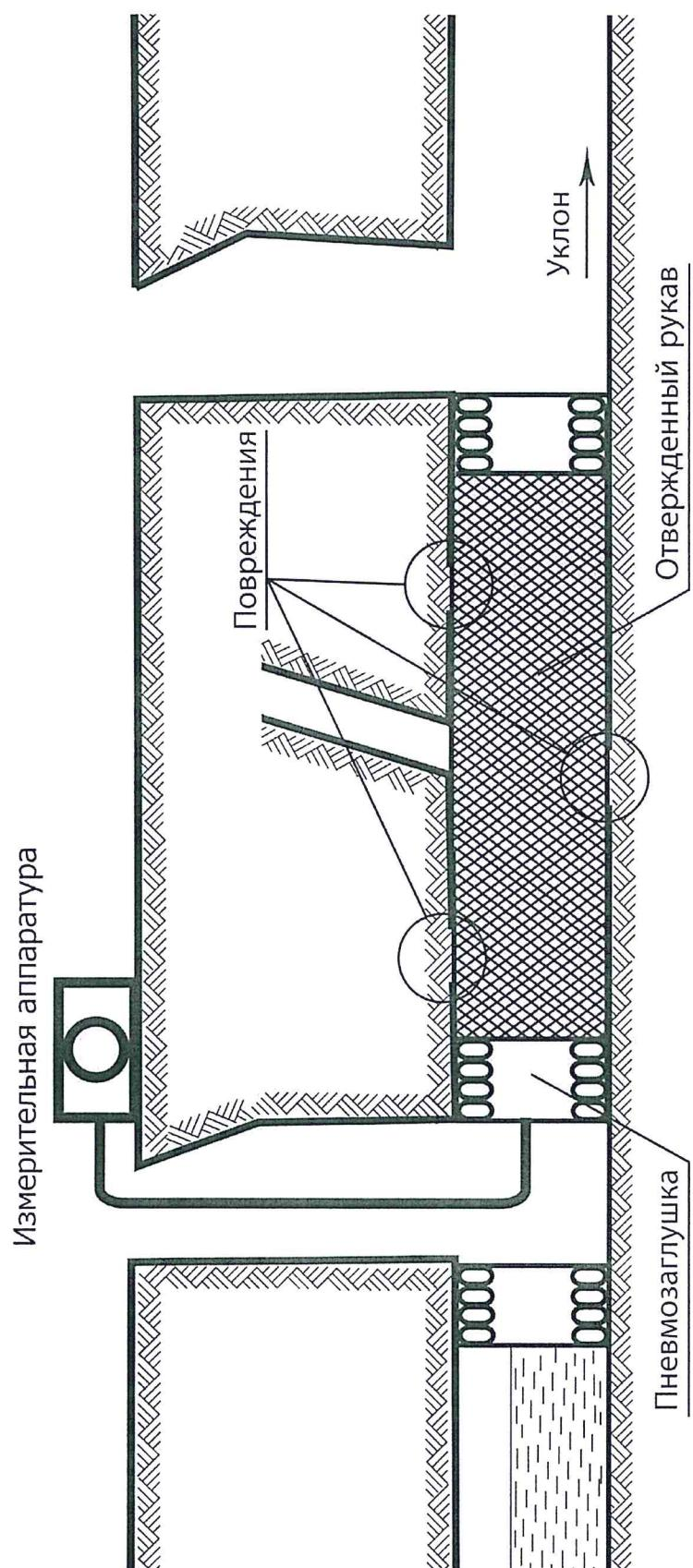
Рисунок 15 — Монтаж гибких полимерных рукавов, отверждаемых УФ – излучением.
