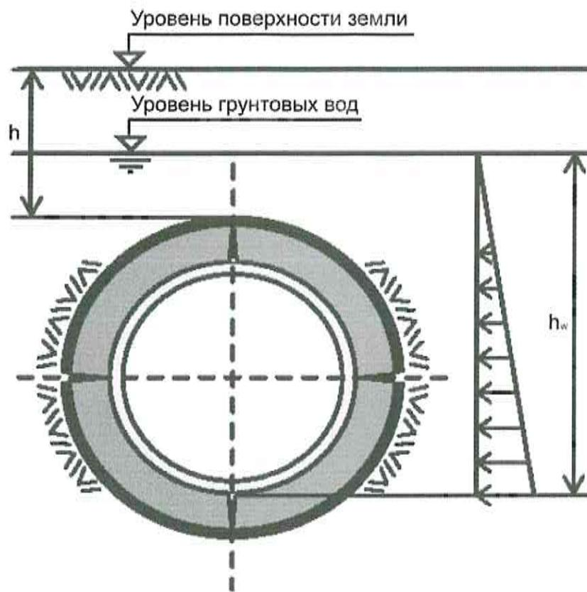
Рисунок 3 — Система «старая труба – грунт». Класс состояния 2
