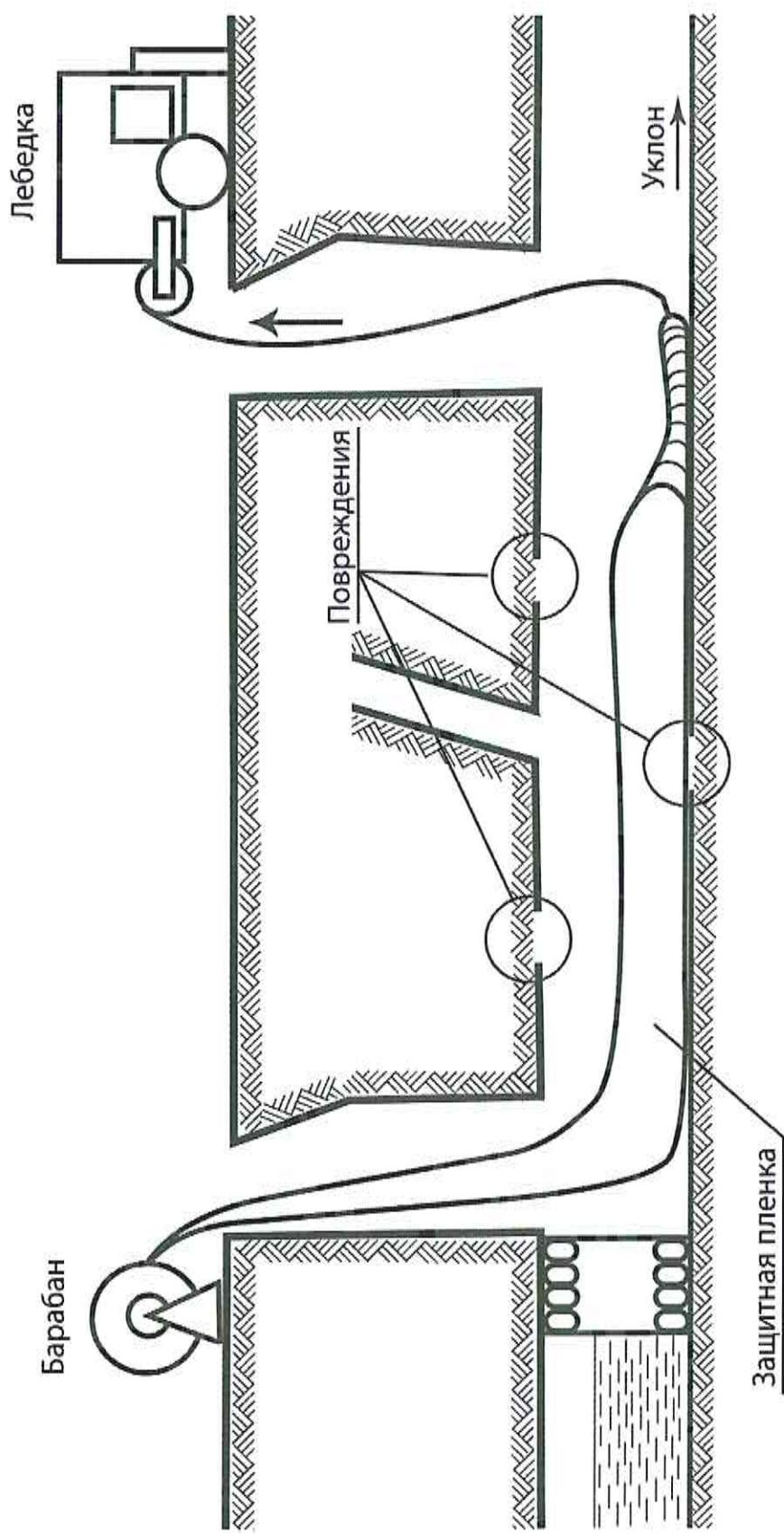
Рисунок 10 — Монтаж гибких полимерных рукавов, отверждаемых УФ - излучением. Втягивание защитной пленки
