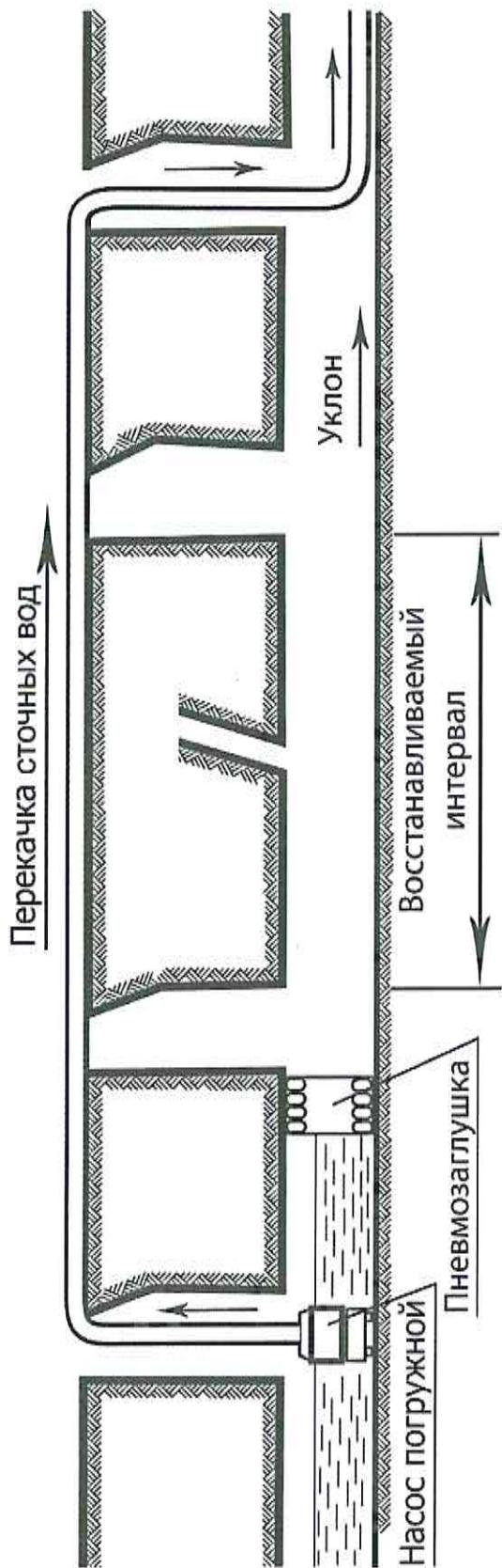
Рисунок 5 — Подготовительные работы. Устройство водоотведения
