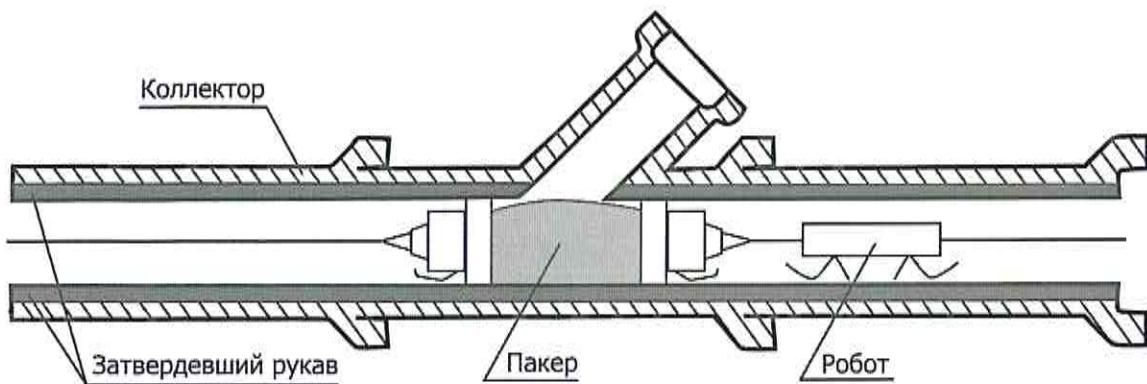
Этап 1. Раскрытие примыкания с помощью робота для фрезерных работ.
