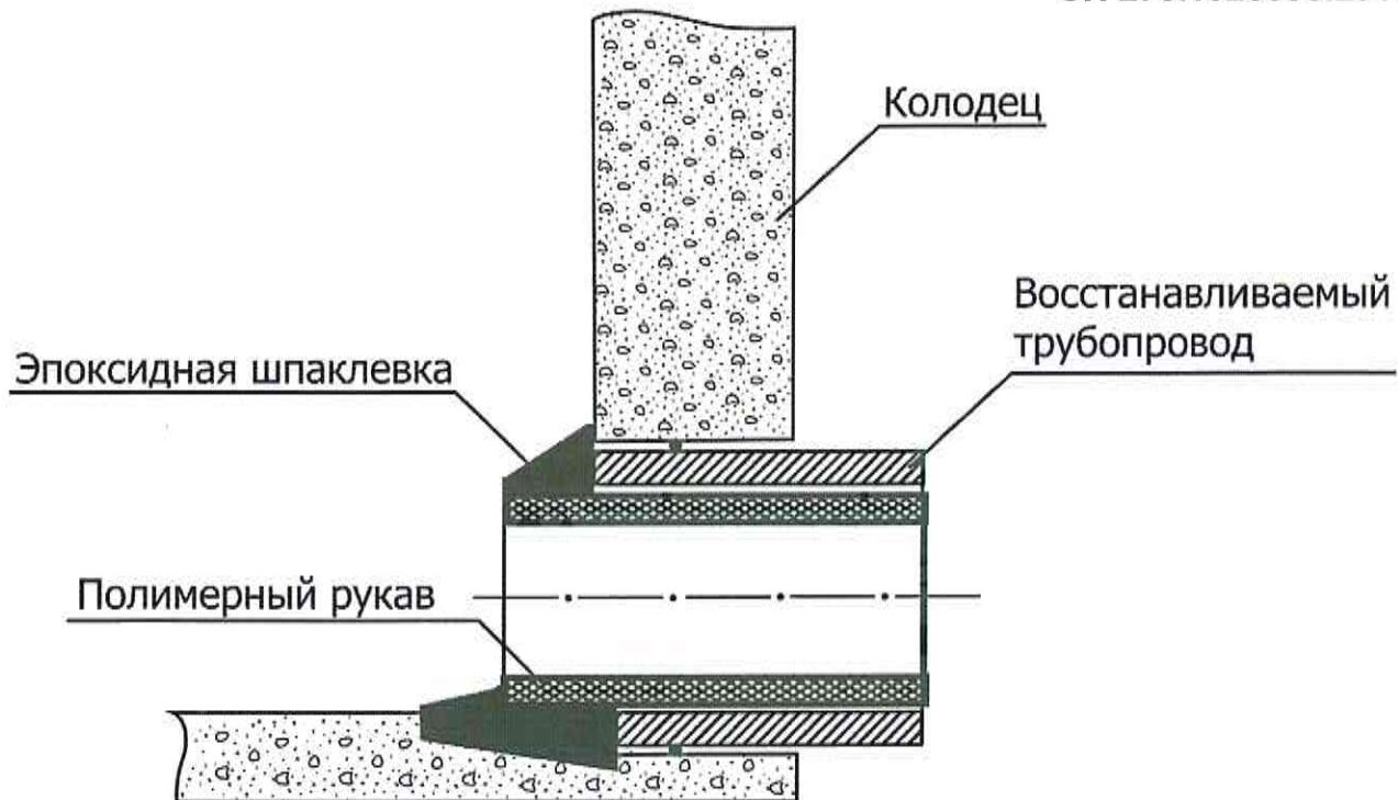
Рисунок 21 — Устройство примыкания с применением эпоксидной шпаклевки
