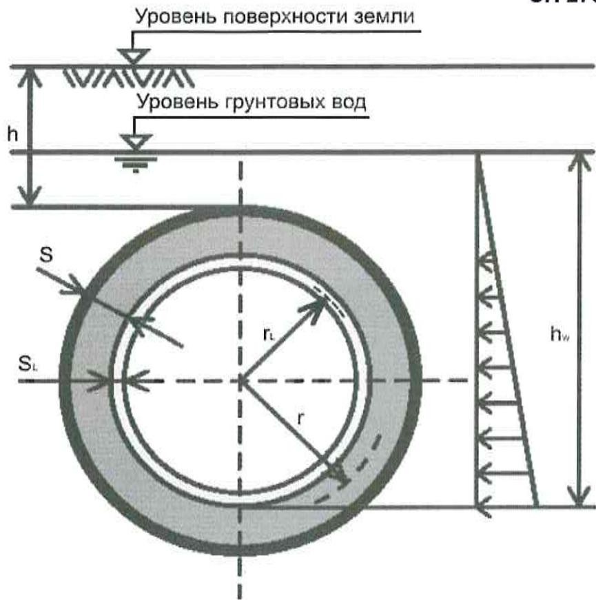
$h$  – толщина слоя грунта;  $s$  – толщина стенки старого трубопровода;
