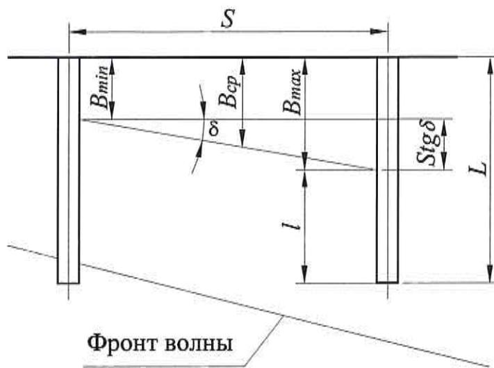
$L$  – длина буны;  $l$  – морской отрезок буны;  $S$  – расстояние между бунами;  $B_{\min}$  – минимальная ширина пляжа;  $B_{\max}$  – максимальная ширина пляжа
