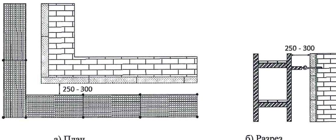
**Рисунок 8.1 – Схема установочных параметров строительных лесов**
