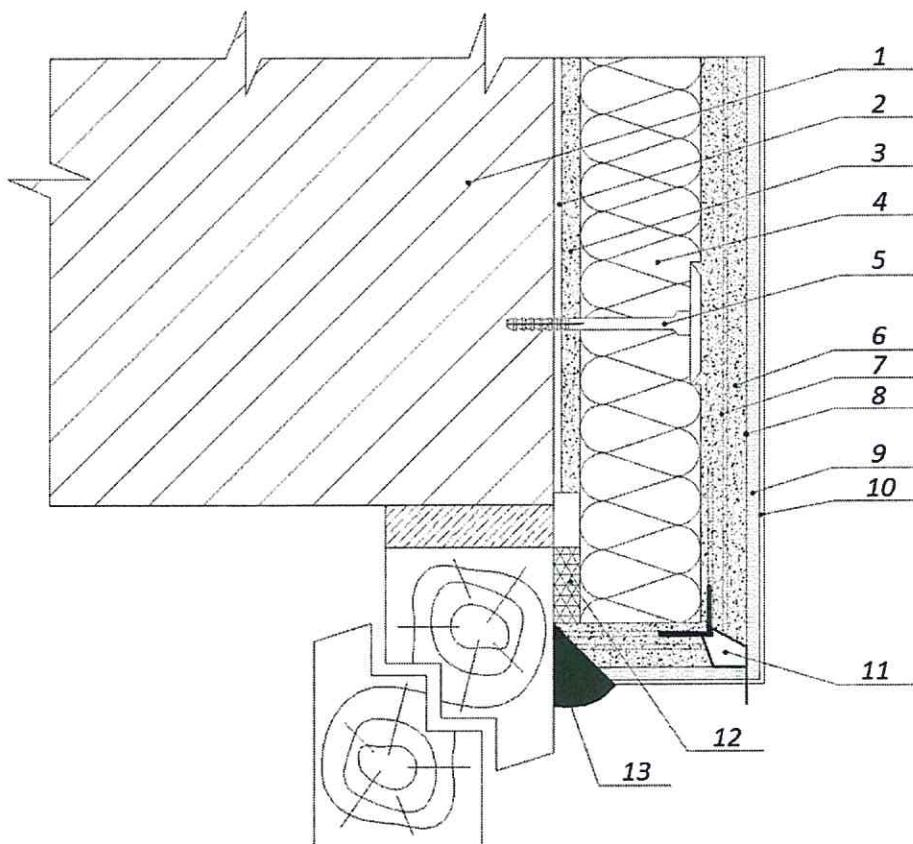
1 – основание; 2 – пропитывающий укрепляющий грунт\*; 3 – клеевой слой; 4 – теплоизоляционный слой; 5 – анкер с тарельчатым дюбелем; 6 – армированный базовый штукатурный слой; 7 – фасадная стеклосетка; 8 – адгезионный грунт\*; 9 – декоративно-защитный финишный слой; 10 – окрасочный состав\*; 11 – угловой профиль-капельник с фасадной стеклосеткой; 12 – уплотнительная лента или полиуретановая пена; 13 – фасадный герметик или примыкающий профиль с уплотнительной лентой
