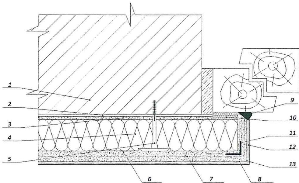
1 – основание; 2 – пропитывающий укрепляющий грунт\*; 3 – клеевой слой; 4 – теплоизоляционный слой; 5 – анкер с тарельчатым дюбелем; 6 – армированный базовый штукатурный слой; 7 – фасадная стеклосетка; 8 – адгезионный грунт\*; 9 – фасадный герметик или примыкающий профиль с уплотнительной лентой; 10 – уплотнительная лента или полиуретановая пена; 11 – угловой профиль с фасадной стеклосеткой; 12 – окрасочный состав\*; 13 – декоративно-защитный финишный слой
