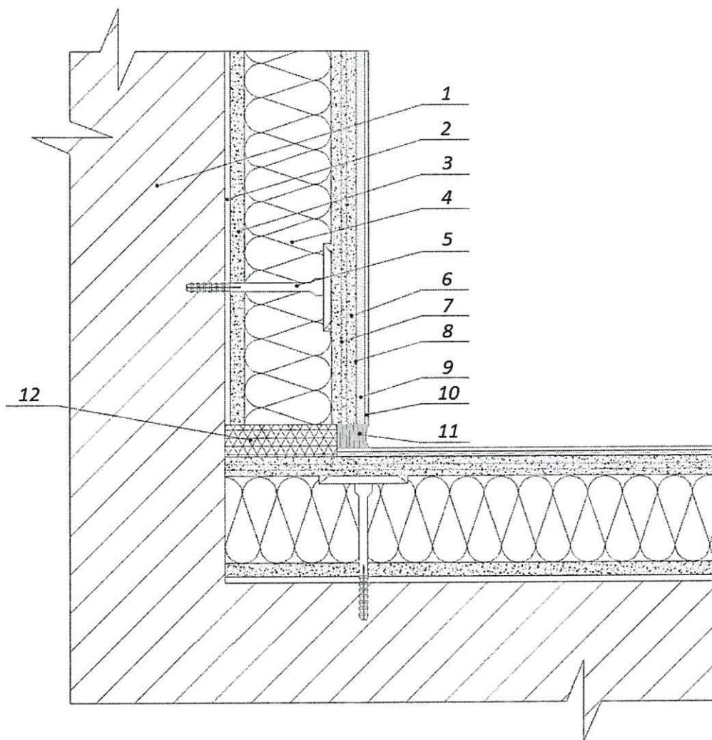
1 – основание; 2 – пропитывающий укрепляющий грунт\*; 3 – клеевой слой; 4 – теплоизоляционный слой; 5 – анкер с тарельчатым дюбелем; 6 – армированный базовый штукатурный слой; 7 – фасадная стеклосетка; 8 – адгезионный грунт\*; 9 – декоративно-защитный финишный слой; 10 – окрасочный состав\*; 11 – фасадный герметик или примыкающий профиль с уплотнительной лентой; 12 – уплотнительная лента или полиуретановая пена
