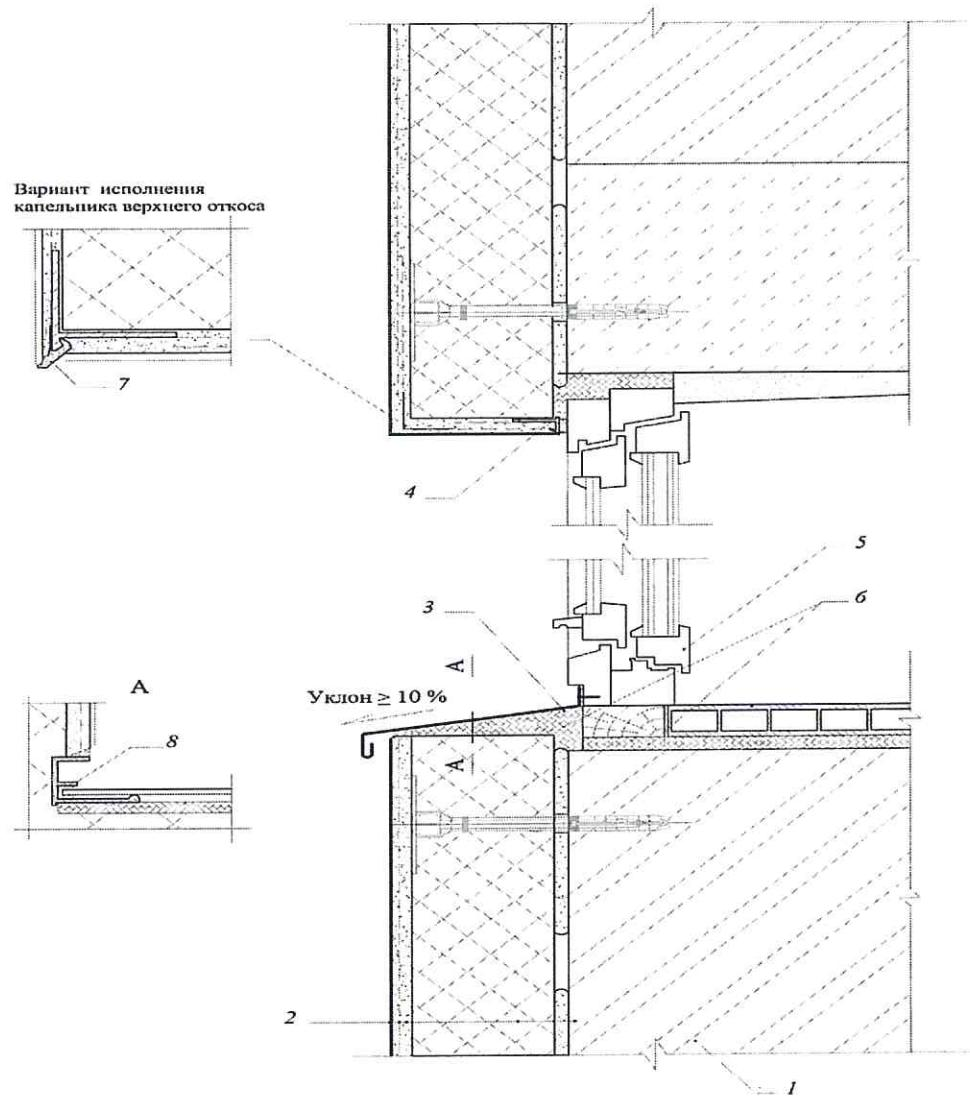
1 – наружная стена\*; 2 – слои СФТК\*\*; 3 – отлив; 4 – примыкающий профиль с уплотнительной лентой; 5 – оконный блок; 6 – монтажная полиуретановая пена; 7 – профиль с капельником; 8 – торцевая заглушка отлива;  $\delta_{yt}$  – толщина теплоизоляционного слоя
