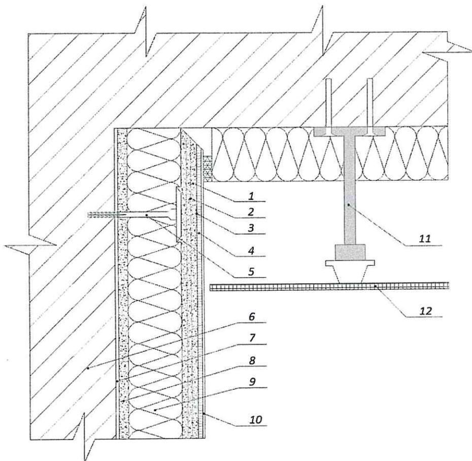
1 – армированный базовый штукатурный слой; 2 – фасадная стеклосетка; 3 – адгезионный грунт\*; 4 – декоративно-защитный финишный слой; 5 – анкер с тарельчатым дюбелем; 6 – основание; 7 – пропитывающий укрепляющий грунт\*; 8 – клеевой слой; 9 – теплоизоляционный слой; 10 – окрасочный состав\*; 11 – крепежный элемент системы вентилируемого фасада; 12 – облицовочный слой системы вентилируемого фасада
