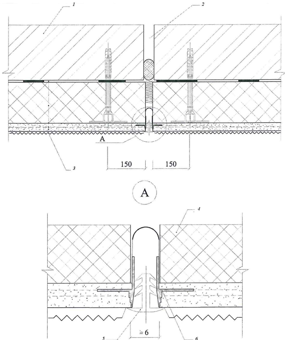
1 – наружная стена\*; 2 – деформационный шов стены; 3 – СФТК; 4 – теплоизоляция; 5 – декоративная заглушка\*\*; 6 – деформационный профиль
