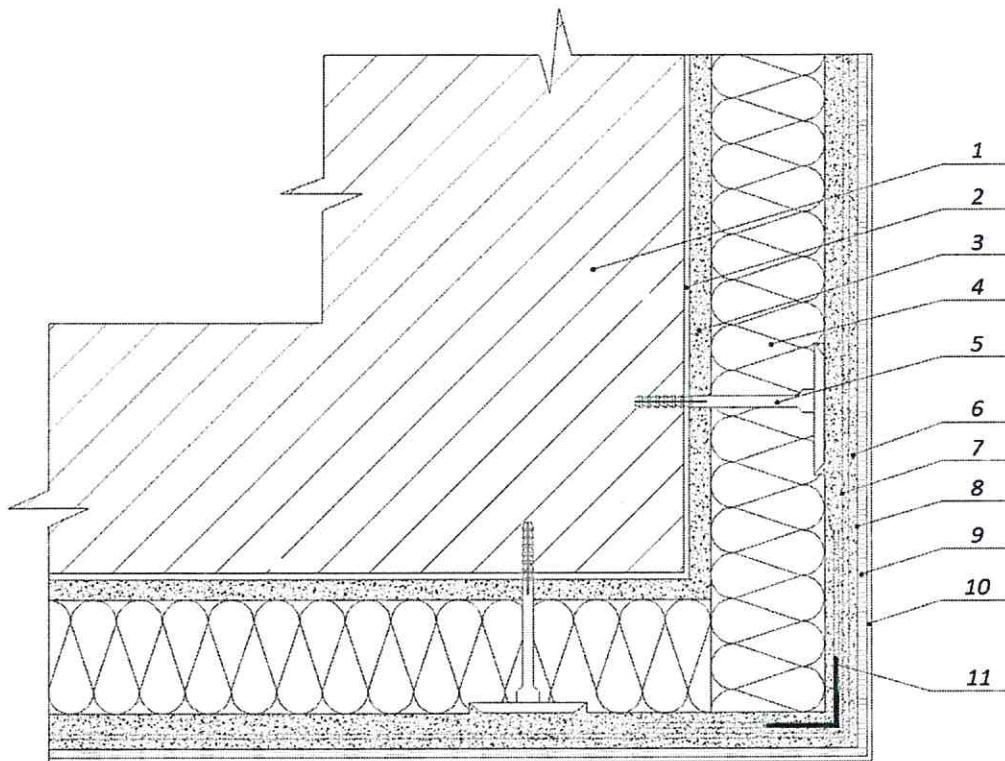
1 – основание; 2 – пропитывающий укрепляющий грунт\*; 3 – клеевой слой; 4 – теплоизоляционный слой; 5 – анкер с тарельчатым дюбелем; 6 – армированный базовый штукатурный слой; 7 – фасадная стеклосетка; 8 – адгезионный грунт\*; 9 – декоративно-защитный финишный слой; 10 – окрасочный состав\*; 11 – угловой профиль с фасадной стеклосеткой
