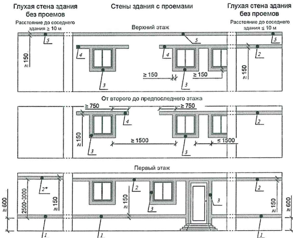
Места расположения противопожарных рассечек: 1 – в районе цоколя здания; 2 – над оконным проемом по всему периметру здания; 2\* – на высоте 2,5–3 м и от нижней отметки системы по всему периметру глухого торца здания; 3 – вокруг оконных и дверных проемов; 4 – вынос рассечки в сторону от оконного проема; 5 – по периметру примыкания к кровле
