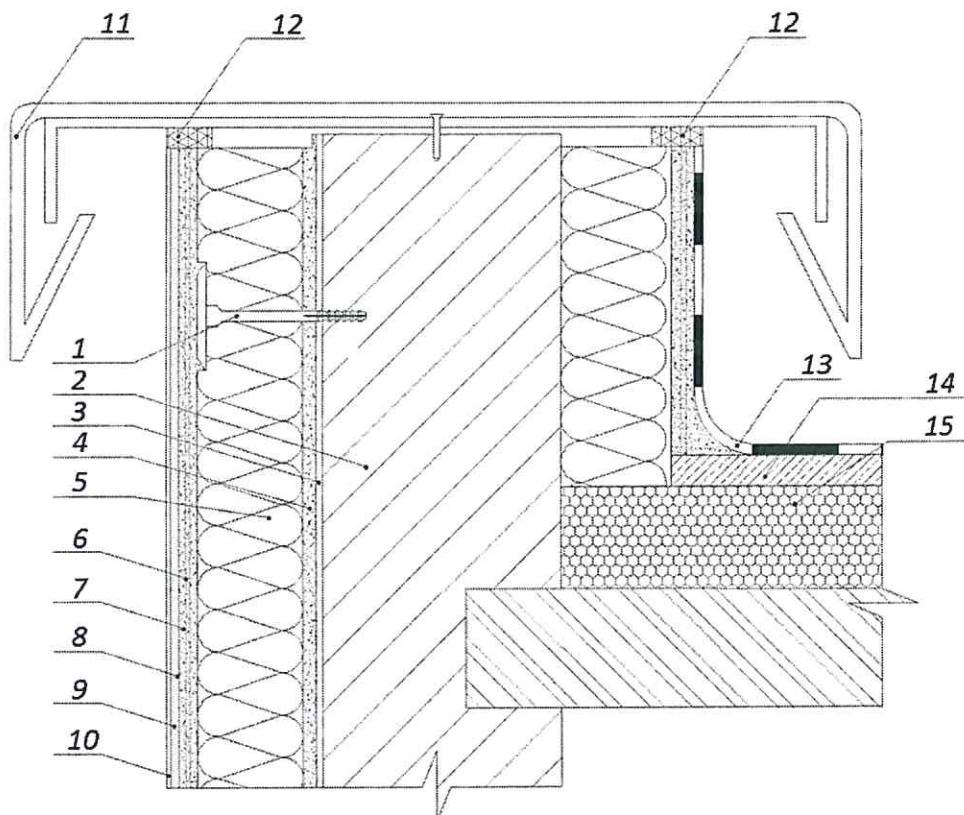
1 – анкер с тарельчатым дюбелем; 2 – основание; 3 – пропитывающий укрепляющий грунт\*; 4 – клеевой слой; 5 – теплоизоляционный слой; 6 – армированный базовый штукатурный слой; 7 – фасадная стеклосетка; 8 – адгезионный грунт\*; 9 – декоративно-защитный финишный слой; 10 – окрасочный состав\*; 11 – козырек парапета (по проекту); 12 – уплотнительная лента или примыкающий профиль с уплотнительной лентой; 13 – гидроизоляция; 14 – стяжка; 15 – теплоизоляционный слой
