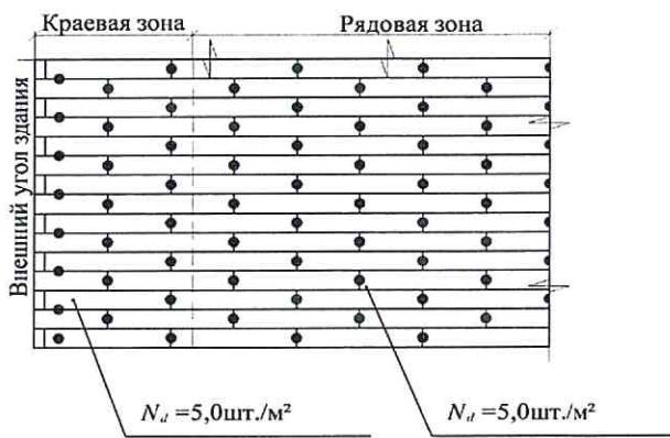
$N_d$  – фактическое количество анкеров с тарельчатым дюбелем на 1 м<sup>2</sup> теплоизоляционного слоя из условий принятой схемы.  $N_d = N_p / S_p$ , где  $N_p$  – число анкеров с тарельчатым дюбелем в проекции теплоизоляционной плиты по плоскости, шт.;  $S_p$  – площадь поверхности теплоизоляционной плиты, м<sup>2</sup>
