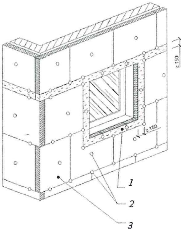
1 – противопожарная рассечка (МВП); 2 – дюбель (расположение показано условно); 3 – плита утеплителя (ППС)
