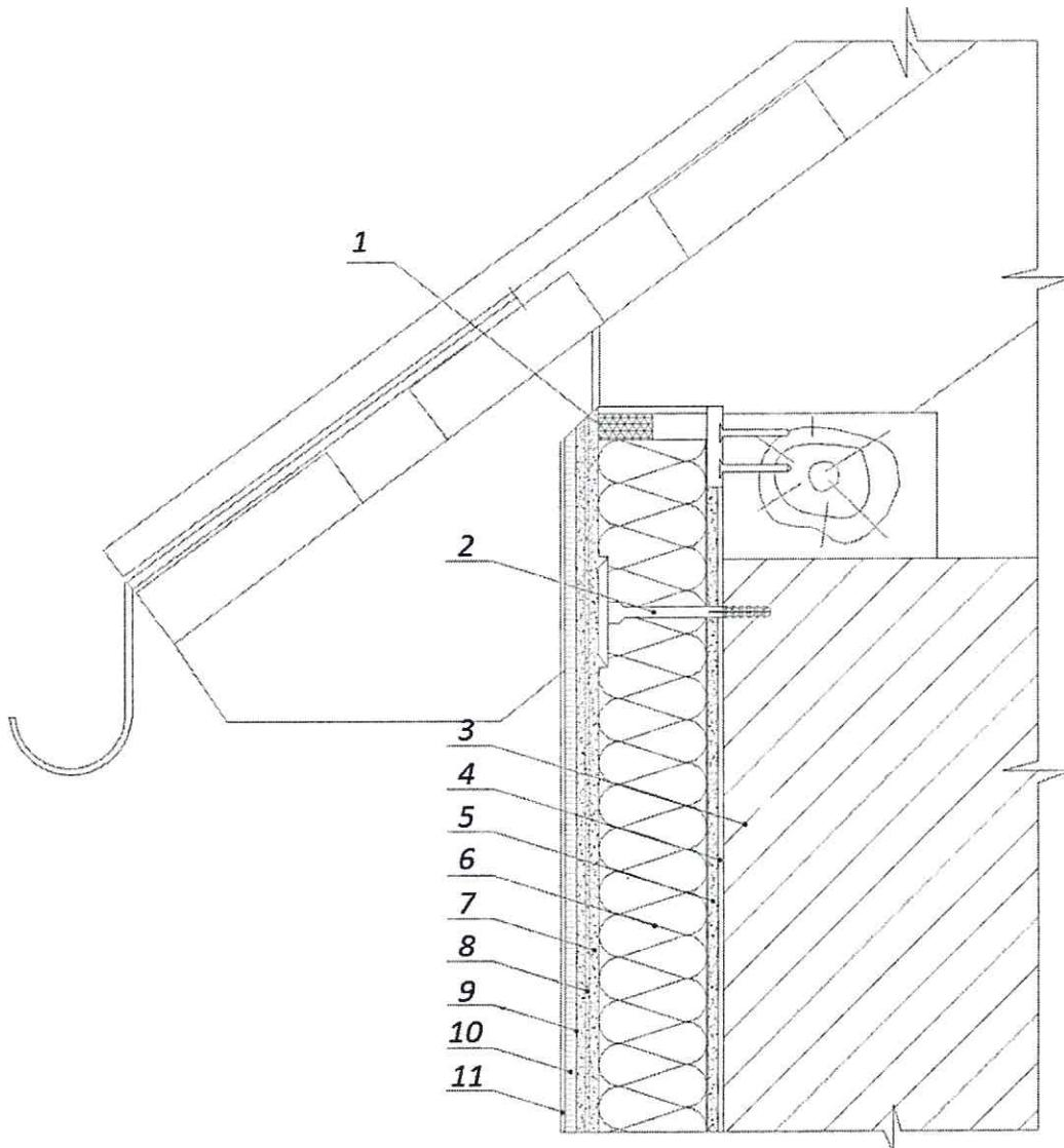
1 – уплотнительная лента или примыкающий профиль с уплотнительной лентой; 2 – анкер с тарельчатым дюбелем; 3 – основание; 4 – пропитывающий укрепляющий грунт\*; 5 – клеевой слой; 6 – теплоизоляционный слой; 7 – армированный базовый штукатурный слой; 8 – фасадная стеклосетка; 9 – адгезионный грунт\*; 10 – декоративно-защитный финишный слой; 11 – окрасочный состав\*
