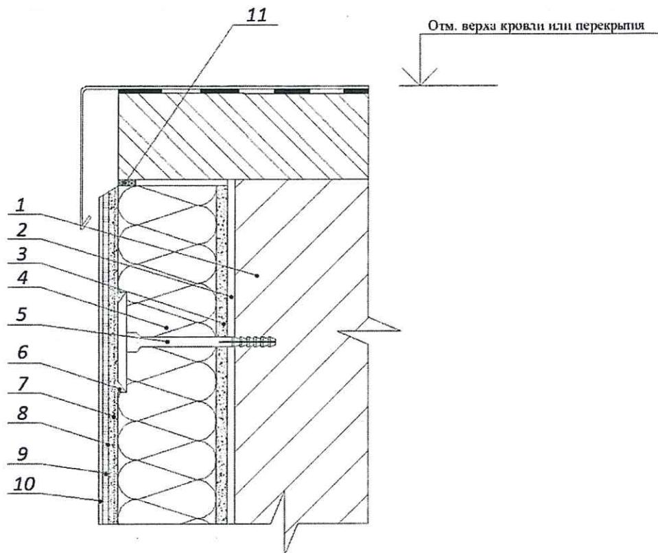
1 – основание; 2 – пропитывающий укрепляющий грунт\*; 3 – клеевой слой; 4 – теплоизоляционный слой; 5 – анкер с тарельчатым дюбелем; 6 – армированный базовый штукатурный слой; 7 – фасадная стеклосетка; 8 – адгезионный грунт\*; 9 – декоративно-защитный финишный слой; 10 – окрасочный состав\*; 11 – уплотнительная лента или примыкающий профиль с уплотнительной лентой
