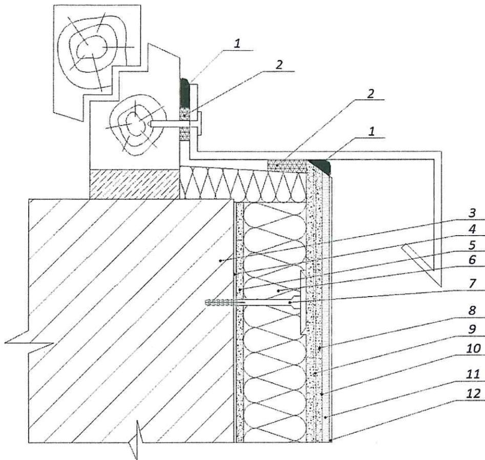
1 – фасадный герметик; 2 – уплотнительная лента; 3 – основание; 4 – пропитывающий укрепляющий грунт\*; 5 – клеевой слой; 6 – теплоизоляционный слой; 7 – анкер с тарельчатым дюбелем; 8 – армированный базовый штукатурный слой; 9 – фасадная стеклосетка; 10 – адгезионный грунт\*; 11 – декоративно-защитный финишный слой; 12 – окрасочный состав\*
