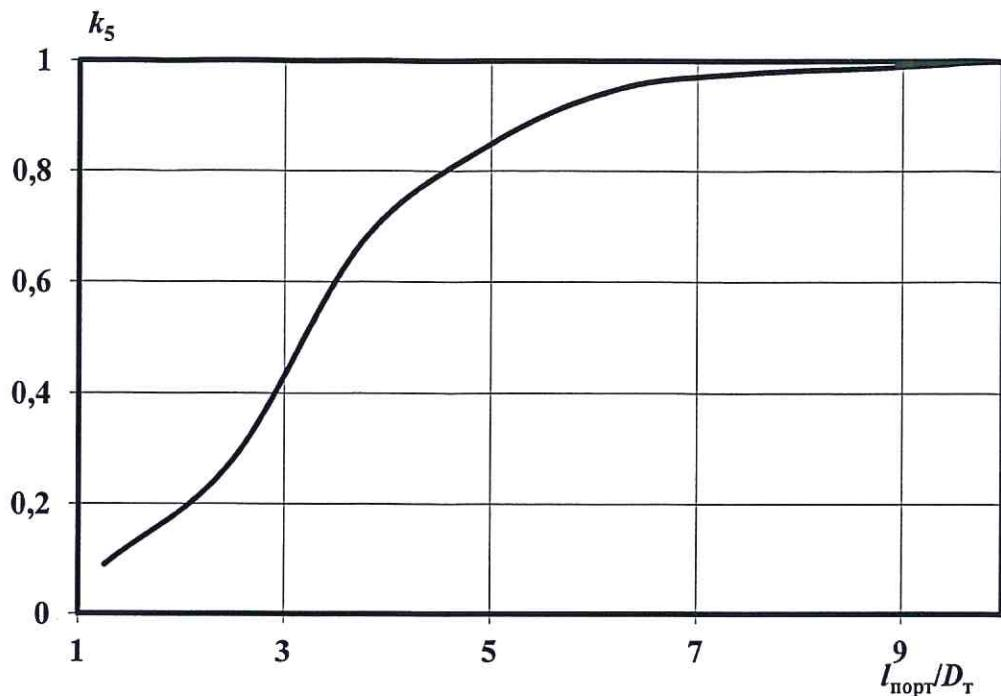
**Рисунок 6.10 – Значение коэффициента  $k_5$  в функции относительного расстояния от места установки ближайших к порталу с исходящей воздушной струей струйных вентиляторов до этого портала  $l_{\text{порт}}/D_t$**
