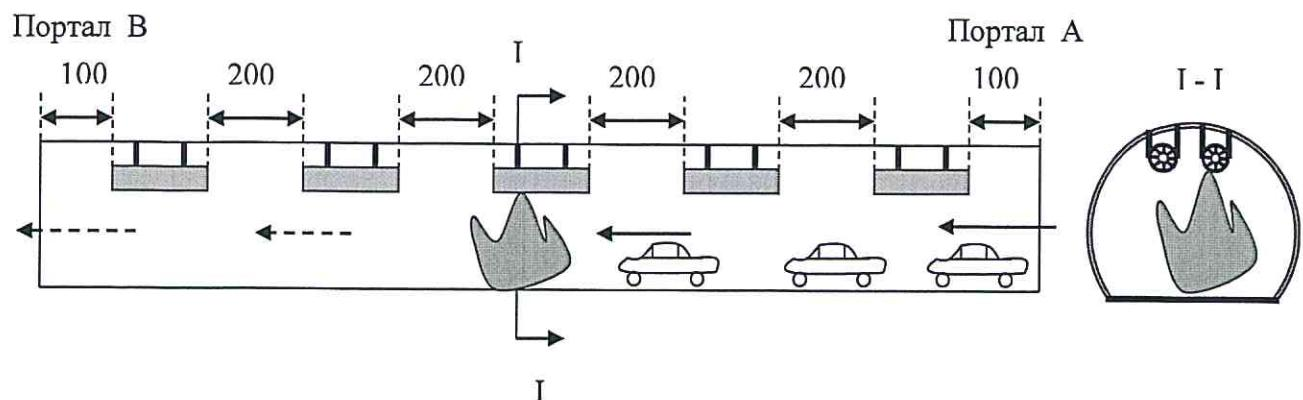
Рисунок И.1 – Аварийный режим проветривания автодорожного тоннеля
