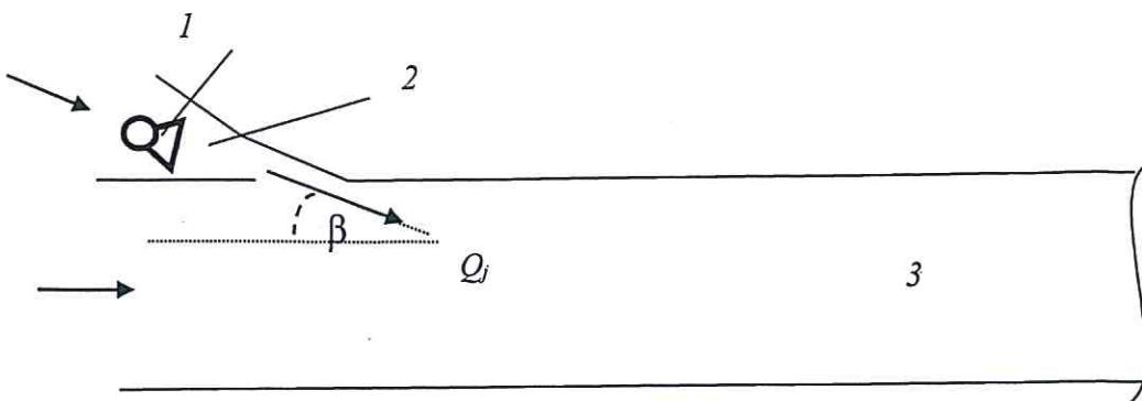
1 – вентилятор; 2 – вентиляционный канал; 3 – тоннель
