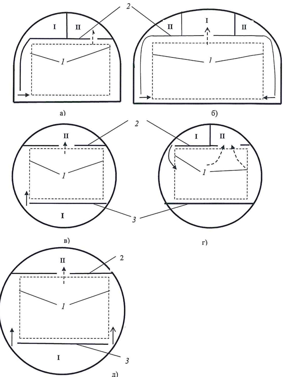
а), б) – проходка тоннеля горным способом соответственно для двух и трех полос движения автотранспорта; в), г), д) – проходка тоннеля механизированным щитом соответственно для двух и трех полос движения
