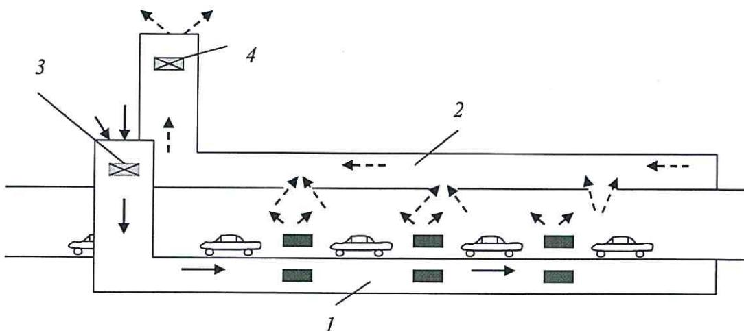
1 – подающий канал; 2 – отводящий канал; 3 – нагнетательный вентилятор;
