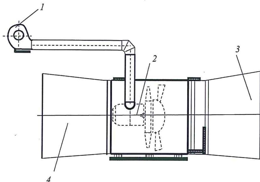
1 – вентилятор; 2 – электродвигатель; 3 – конфузор; 4 – диффузор
