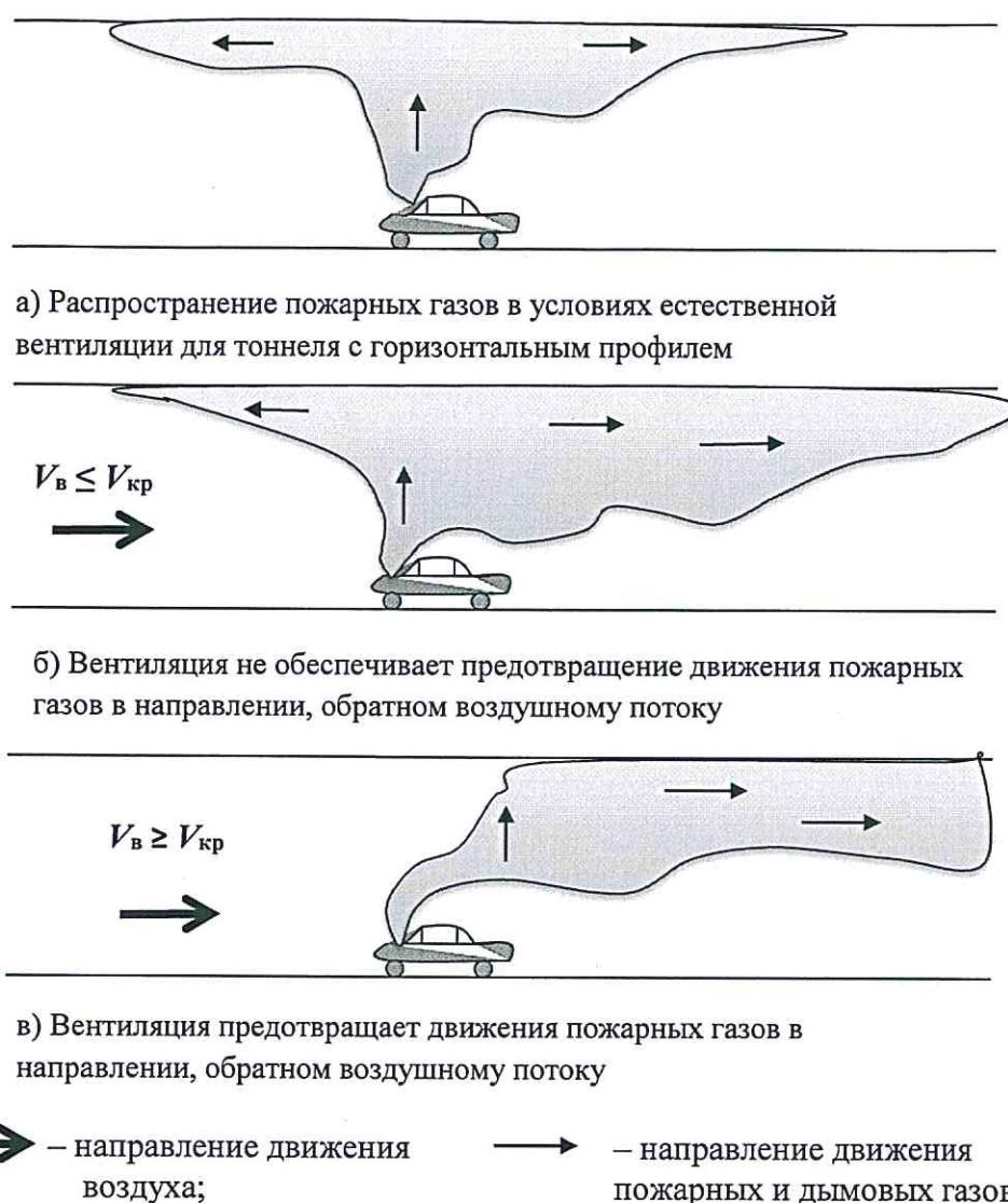
**Рисунок 6.11 – Закономерности формирования обратного вентиляционному потоку движения дыма или горячих газов при возникновении пожара в автодорожном тоннеле в зависимости от скорости воздуха**
