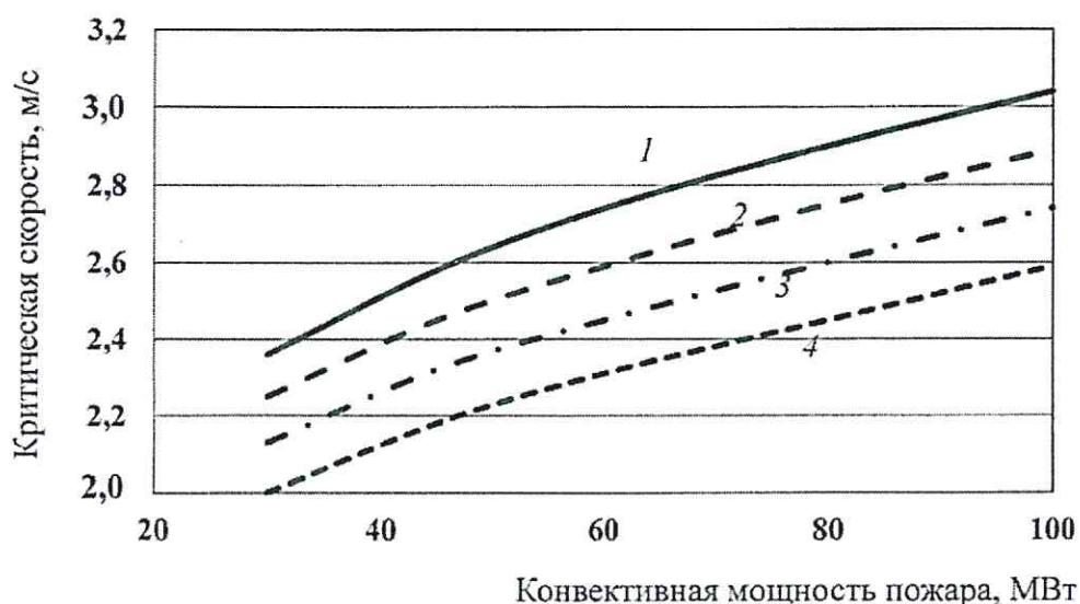
1 – значение уклона тоннеля  $i = 0$ ; 2 – значение уклона тоннеля  $i = -2 \%$ ;
