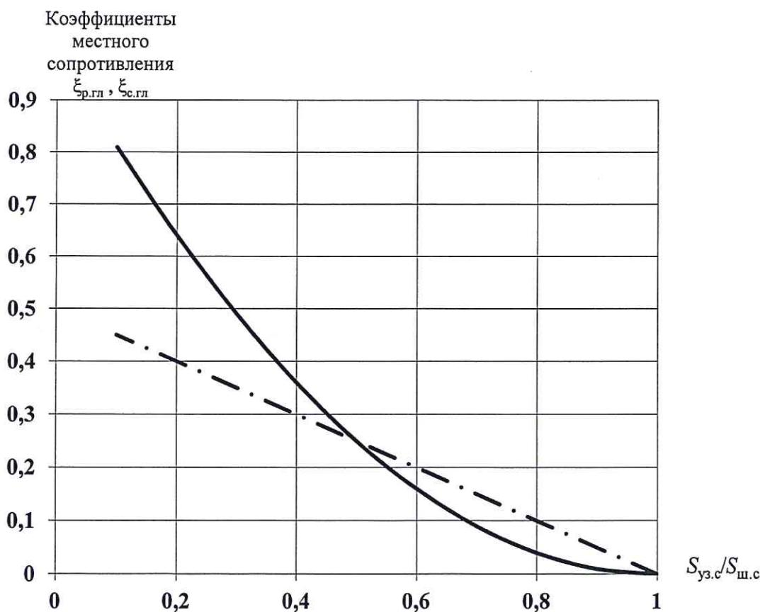
1 –  $\xi_{\text{п.гл}}$ ; 2 –  $\xi_{\text{с.гл}}$ ;  $S_{\text{уз.с}} / S_{\text{ши.с}}$  – соответственно сечения тоннеля в «узком» и «широком» местах
