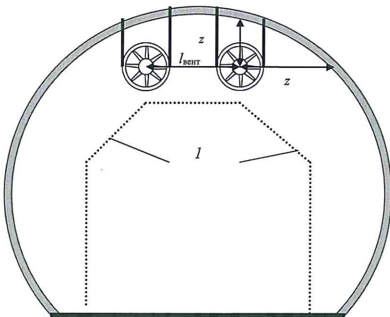
$l_{\text{вент}}$  – расстояние между центрами вентиляторов в сечении тоннеля;  $z$  – расстояние от центра вентилятора до поверхности свода тоннеля;  $I$  – габарит приближения
