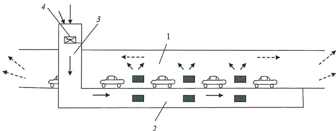
**Рисунок 8.6 – Продольно-поперечная схема вентиляции**
