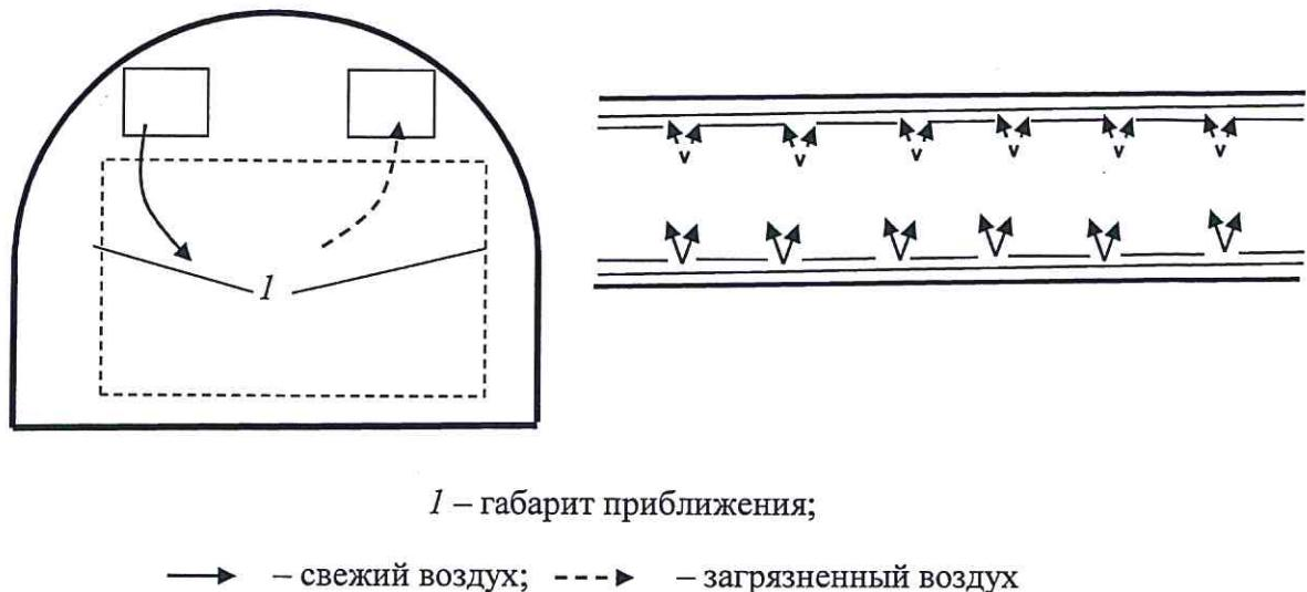
**Рисунок 7.2 – Поперечная система вентиляции, использующая металлические вентиляционные короба**
