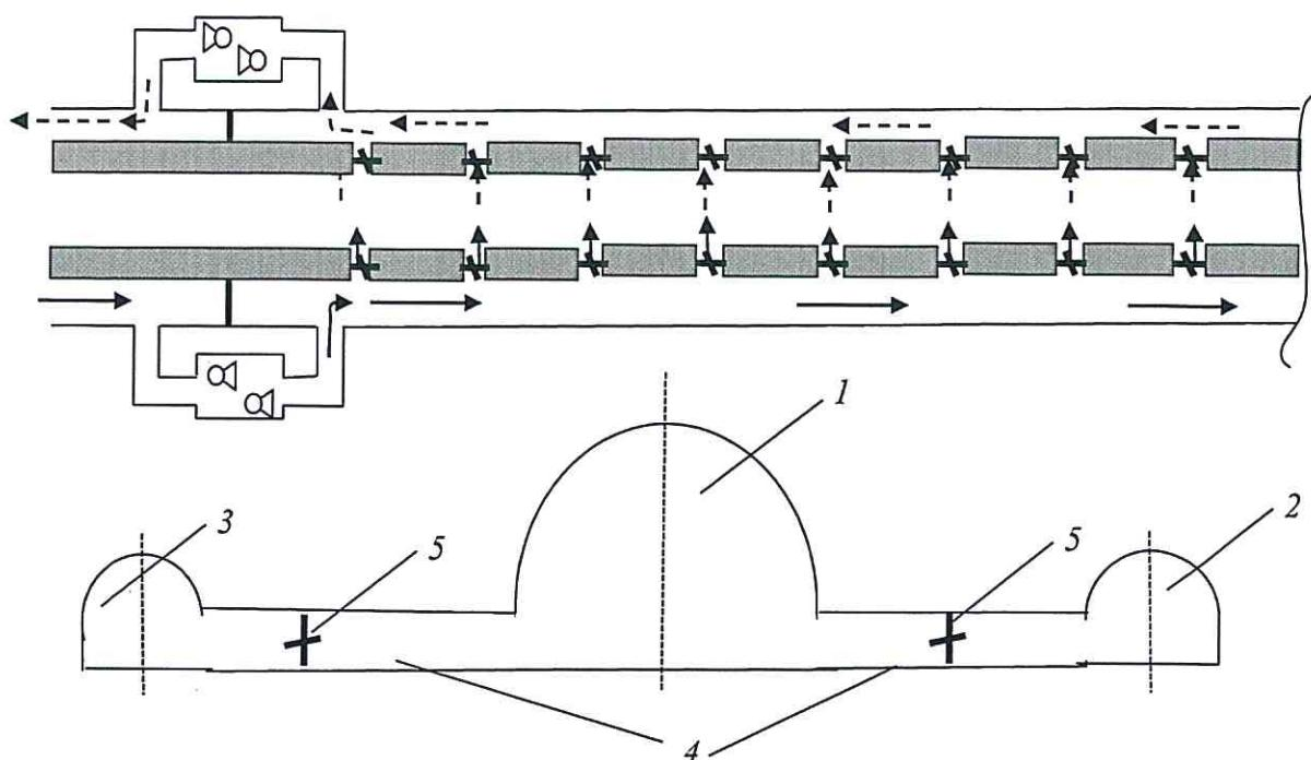
1 – транспортный тоннель; 2 – сервисный тоннель; 3 – вентиляционный тоннель; 4 – сбоки; 5 – клапаны
