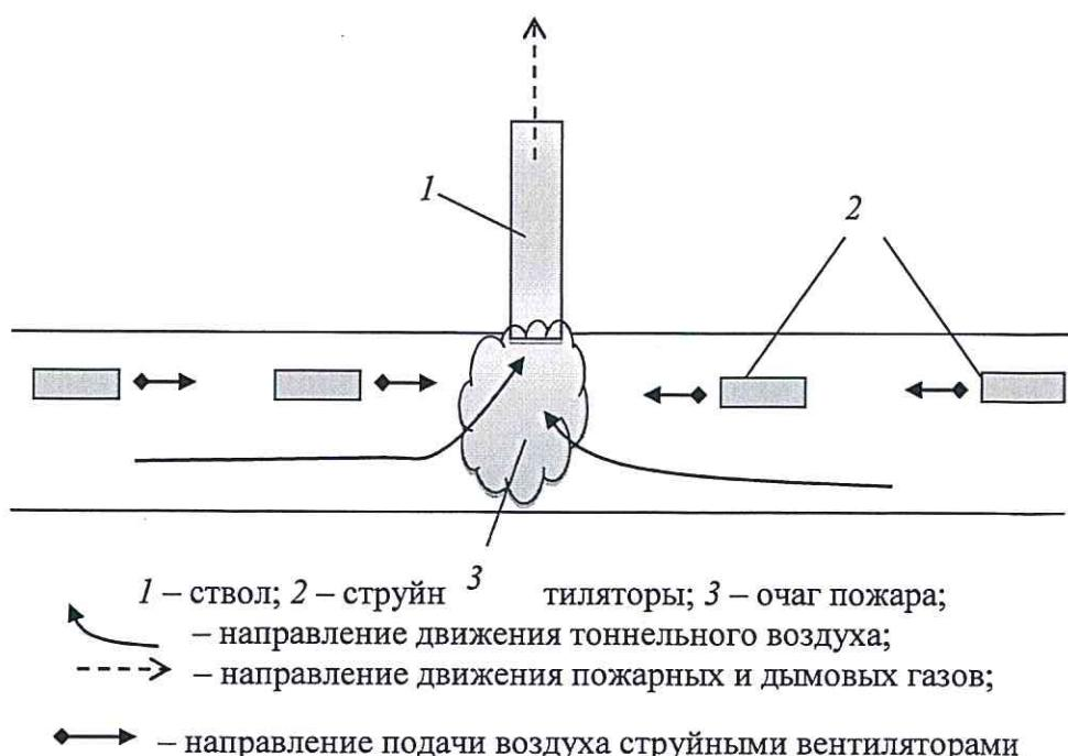
**Рисунок 8.3 – Продольная схема вентиляции с массовой вытяжкой**
