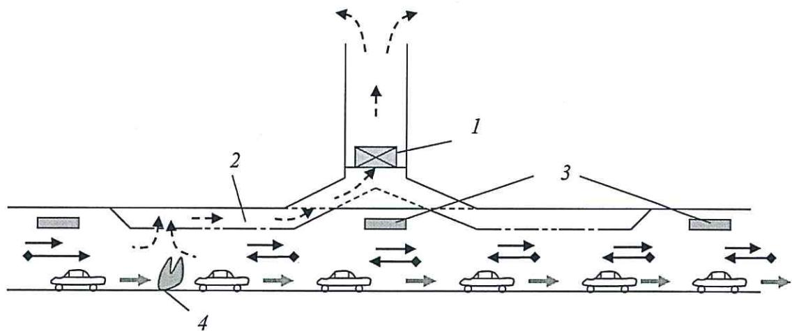
1 – вентилятор дымоудаления; 2 – канал дымоудаления; 3 – струйные вентиляторы; 4 – очаг пожара
