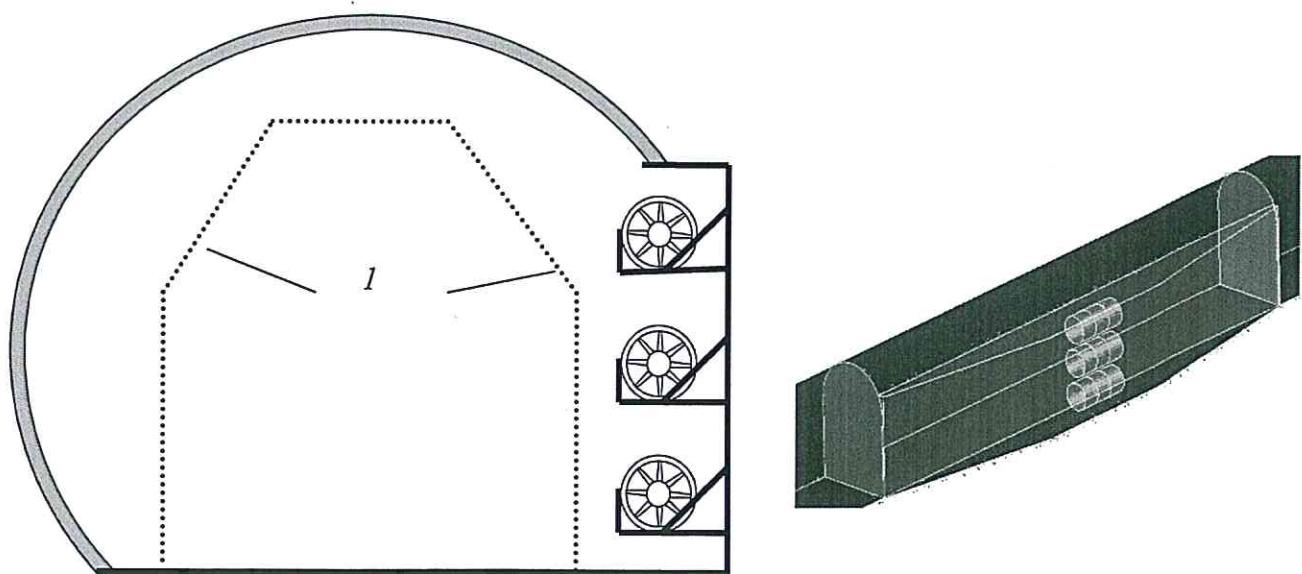
**Рисунок 6.7 – Размещение вентиляторов в боковой нише**
