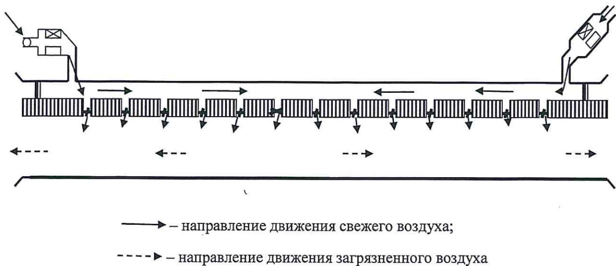
**Рисунок 8.5 – Продольно-поперечная схема вентиляции автодорожного тоннеля при эксплуатационных режимах проветривания**
