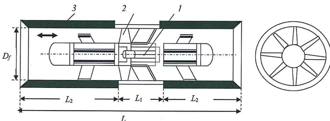
1 – двигатель; 2 – лопатки; 3 – глушители шума;  $L_1$  – длина вентилятора с двигателем и крыльчаткой;  $L_2$  – длина глушителя шума;  $L$  – общая длина струйного вентилятора;  $D_f$  – диаметр выходного отверстия
