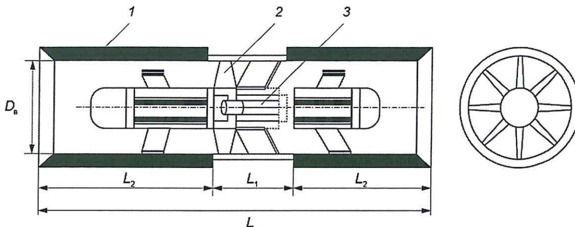
$L$  – общая длина струйного вентилятора;  $L_1$  – длина осевого реверсивного вентилятора с двигателем;  $L_2$  – длина глушителя;
