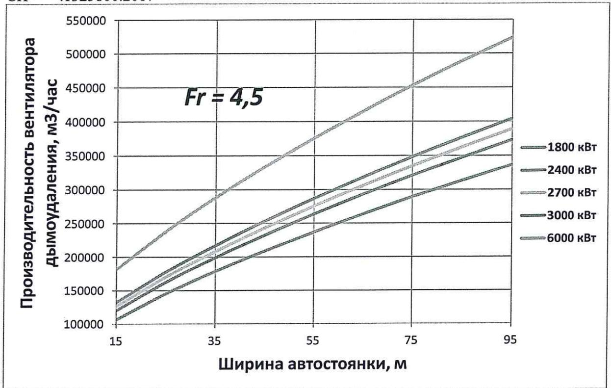
**Рисунок Е.4 – График зависимости производительности вентиляторов дымоудаления  $V_{ex}$  от ширины автостоянки  $B$  при различных значениях конвективной мощности пожара  $Q_k$ , при числе Фруда  $Fr = 4,5$**
