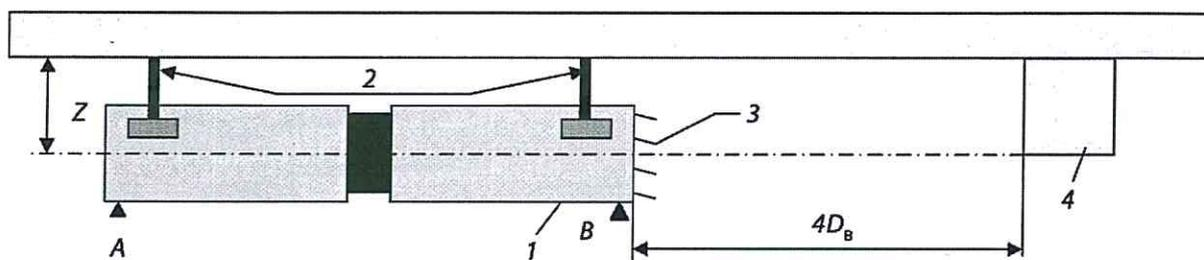
1 – струйный вентилятор; 2 – анкерные болты; 3 – направляющий аппарат;
