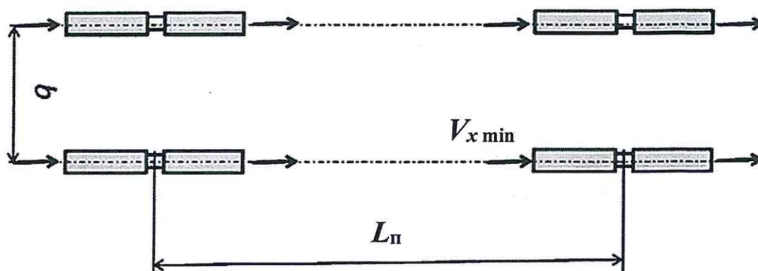
а) Соосная установка струйных вентиляторов
