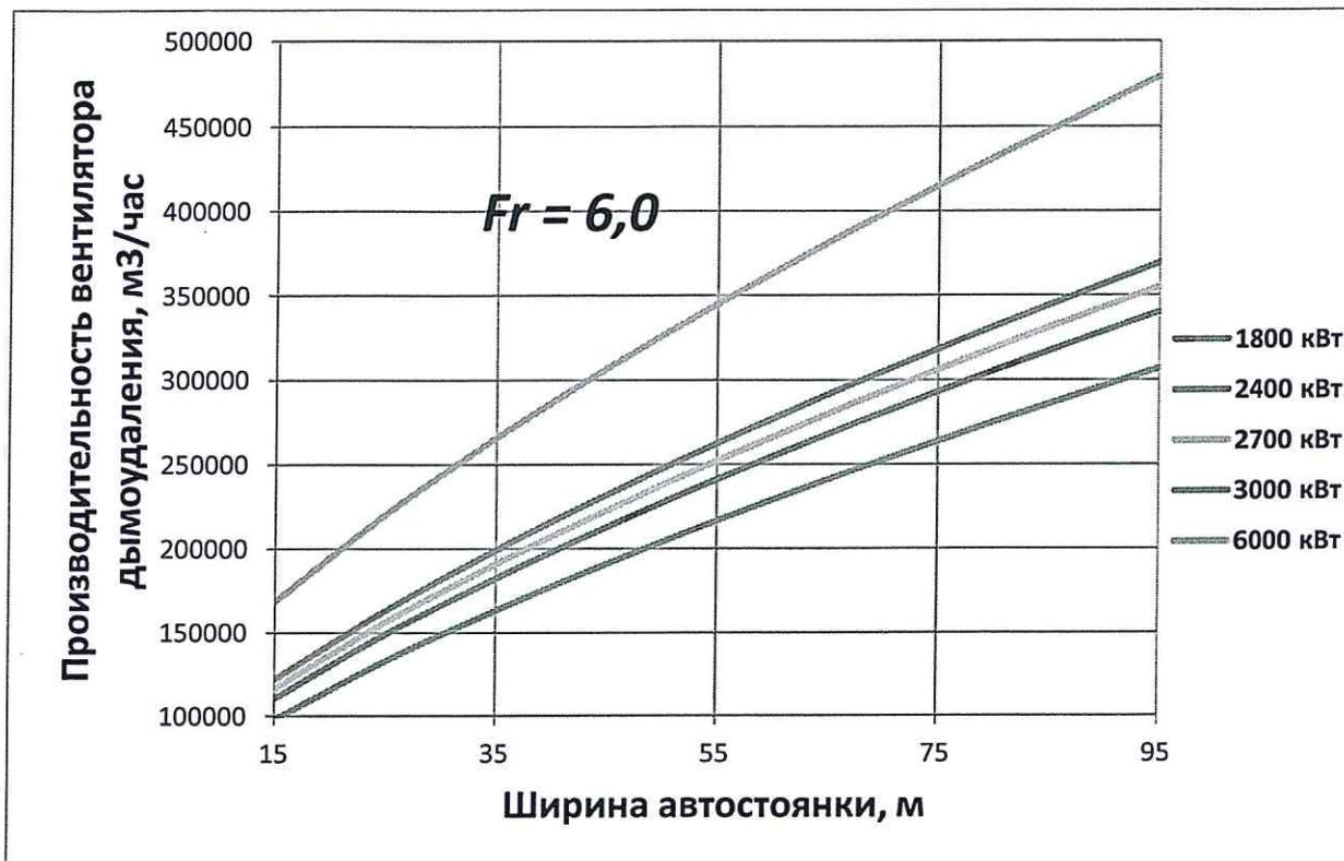
**Рисунок Е.3 – График зависимости производительности вентиляторов дымоудаления  $V_{ex}$  от ширины автостоянки  $B$  при различных значениях конвективной мощности пожара  $Q_k$ , при числе Фруда  $Fr = 6,0$**
