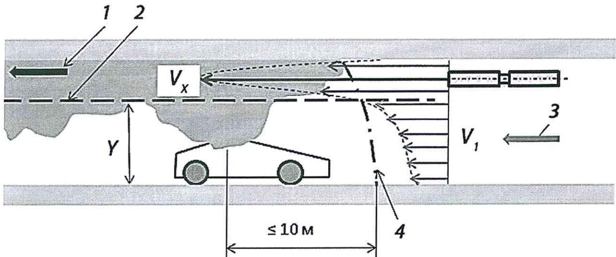
1 – вытяжка; 2 – условная граница раздела разноплотностных потоков воздуха; 3 – приток;
