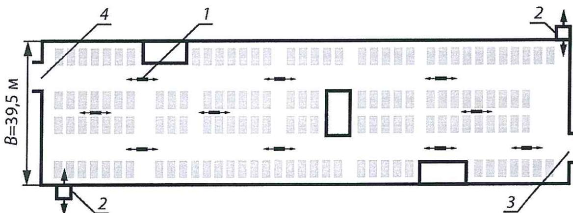
1 – реверсивный струйный вентилятор; 2 – приток-вытяжка (системы приточной и вытяжной противодымных вентиляций соответственно); 3 – въезд; 4 – выезд
