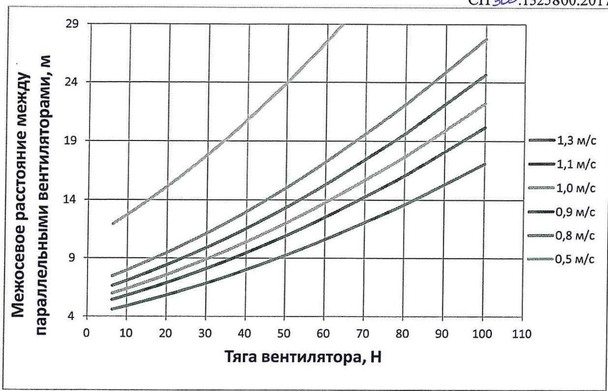
**Рисунок И.2 – График зависимости межсезового расстояния  $b$  от расчетной реактивной тяги вентилятора  $F_p$  при различных значениях  $v_{xmin}$**
