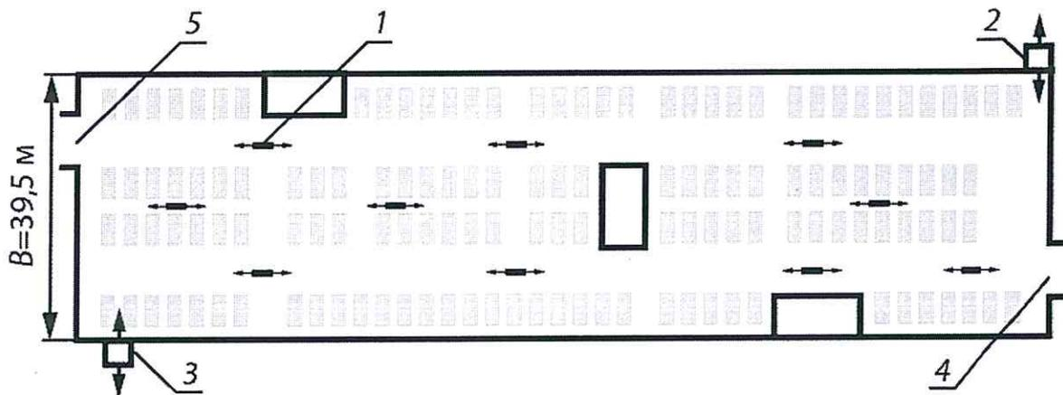
1 – реверсивный струйный вентилятор; 2 – вытяжка (система вытяжной вентиляции); 3 – приток (система приточной вентиляции); 4 – въезд; 5 – выезд
