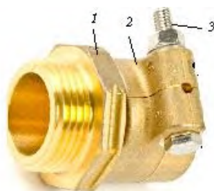
1 – штуцерно-резьбовая деталь (корпус); 2 – стяжная муфта; 3 – стяжной болт
