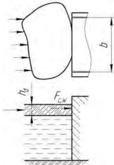
**Рисунок 19 – Схема приложения нагрузки от движущегося ледяного поля на секцию сооружения**
