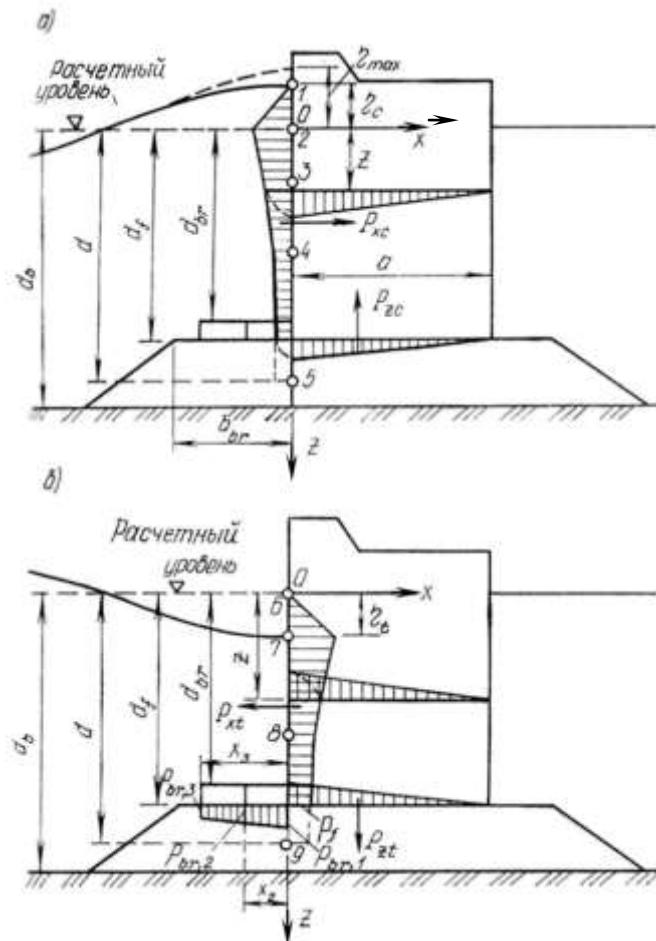
*a* – при гребне волны; *б* – при ложбине волны
