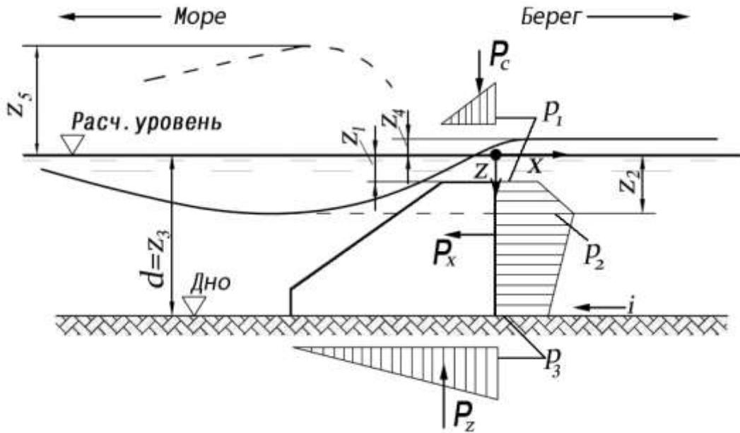
**Рисунок 9 – Эпюры волнового давления на подводный волнолом**
