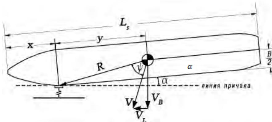
**Рисунок М.1 – Схема контакта судна с причалом**
