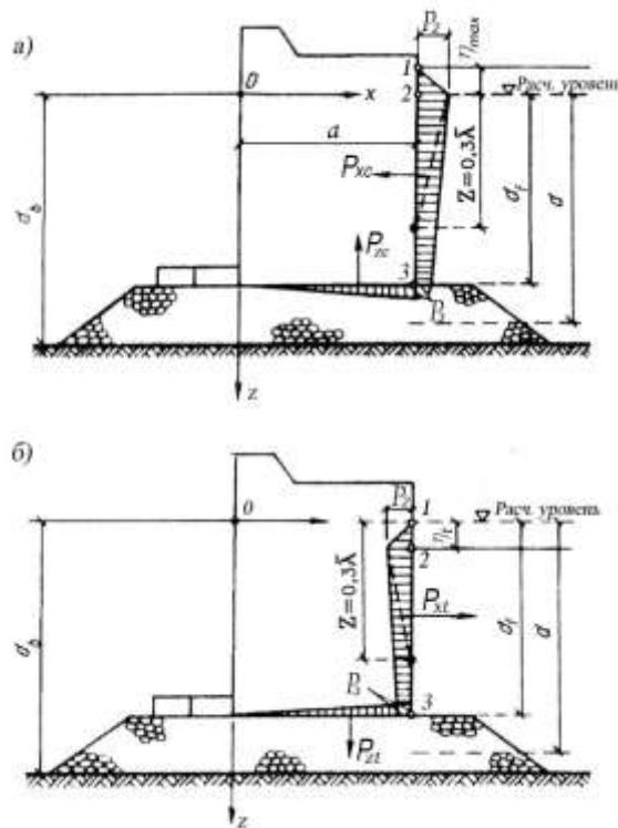
*a – при гребне волны; б – при ложбине волны*
