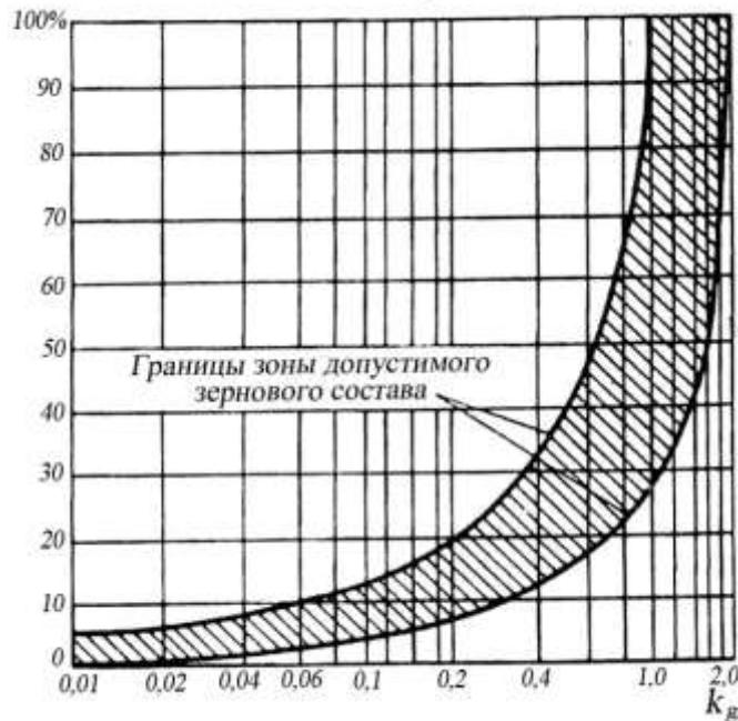
**Рисунок В.2 – График для определения допустимого зернового состава несортированной каменной наброски для крепления откосов**
