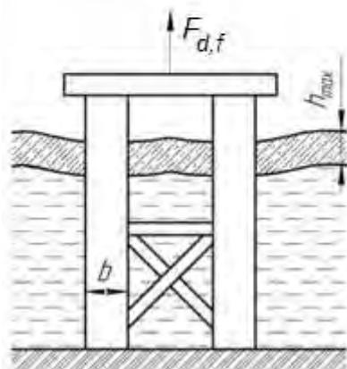
*Рисунок 26 – Схема приложения нагрузки к сооружению, состоящему из системы вертикальных колонн, от примерзшего к нему ледяного покрова при повышении уровня воды (при понижении уровня воды сила  $F_{d,f}$  направлена вниз)*
