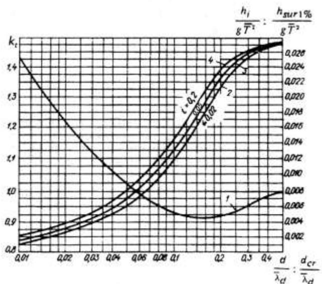
**Рисунок А.5 – Графики для определения значений: коэффициента  $k_t$  (1) и параметра  $d_{cr} / \bar{\lambda}_d$  (2, 3 и 4)**
