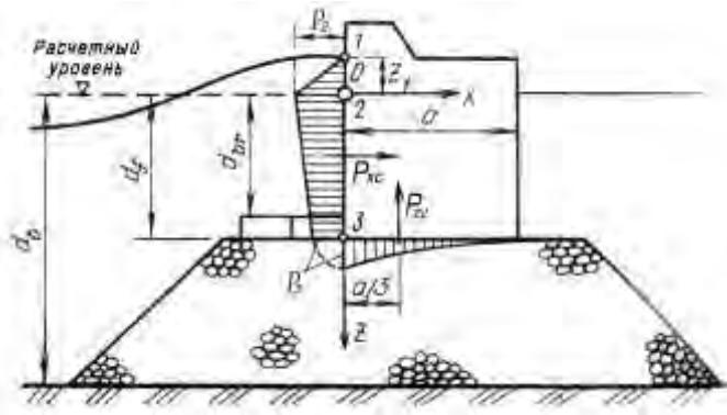
**Рисунок 5 – Эпюры давления разбивающихся волн на вертикальную стену**
