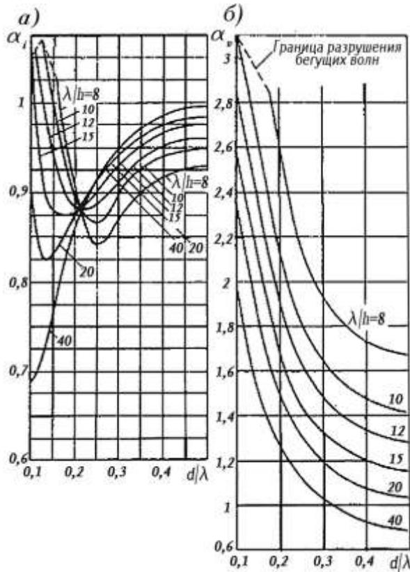
**Рисунок Е.2 – Графики значений инерционного  $\alpha_i$  и скоростного  $\alpha_v$  коэффициентов глубины**
