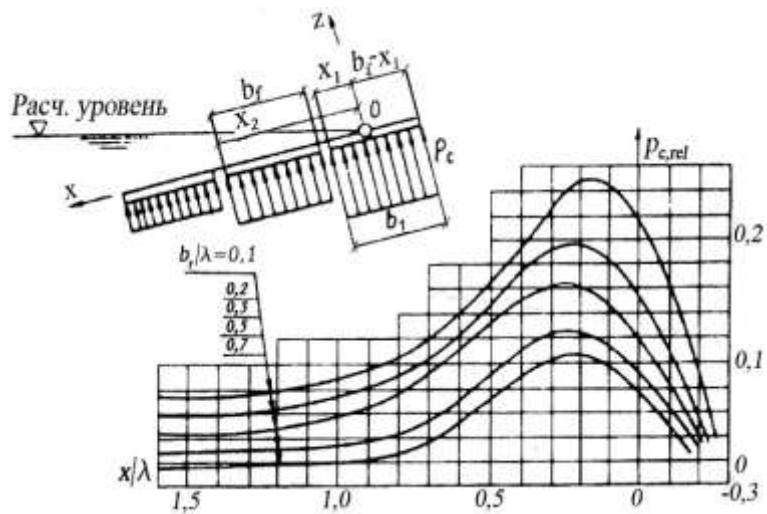
**Рисунок Д.3 – Графики для определения относительного волнового противодавления**
