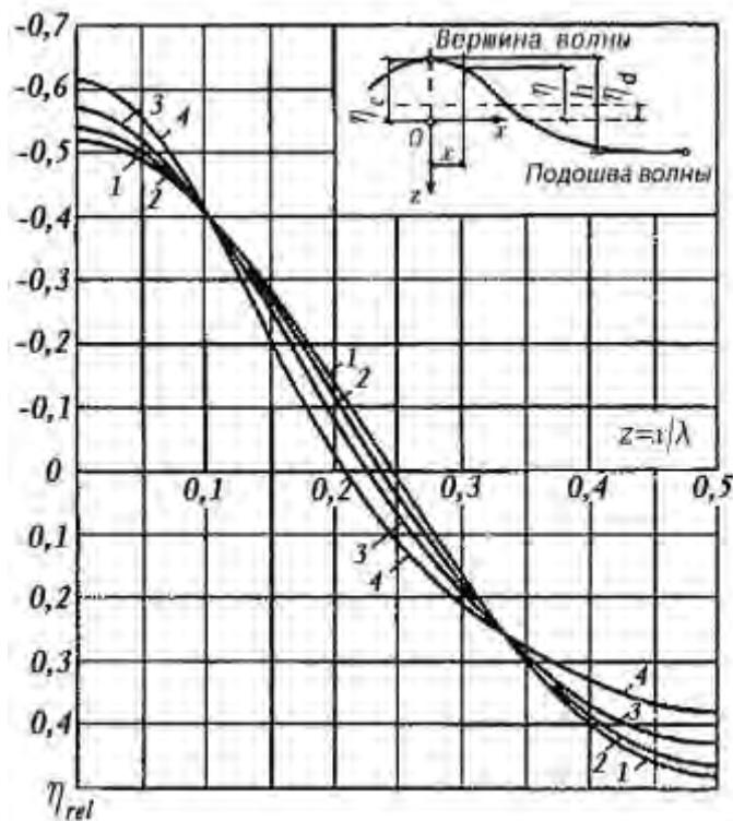
1 – при  $d/\lambda = 0,5$  и  $\lambda/d = 40$ ; 2 – при  $d/\lambda = 0,5$  и  $\lambda/d = 20$ , а также при  $d/\lambda = 0,2$  и  $\lambda/d = 40$ ; 3 – при  $d/\lambda = 0,5$  и  $\lambda/d = 10$ , а также при  $d/\lambda = 0,2$  и  $\lambda/d = 20$ ; 4 – при  $d/\lambda = 0,2$  и  $\lambda/d = 10$
