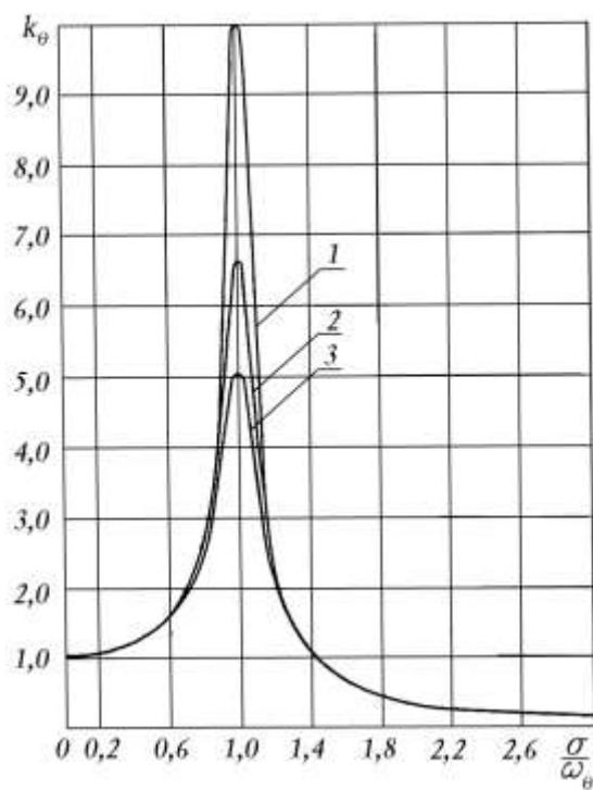
1 – суда без килей; 2 – со склоновыми килями; 3 – со склоновыми килями и бортовыми гребными винтами
