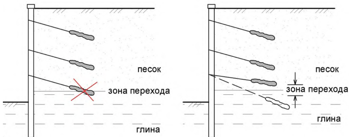
а – недопустимое расположение анкера; б – допустимое расположение
