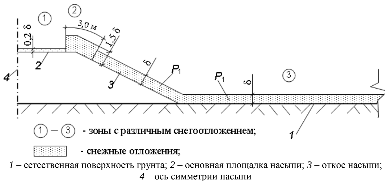
Рисунок Б.2 – Схема снежных отложений при отсутствии снеготранспорта
