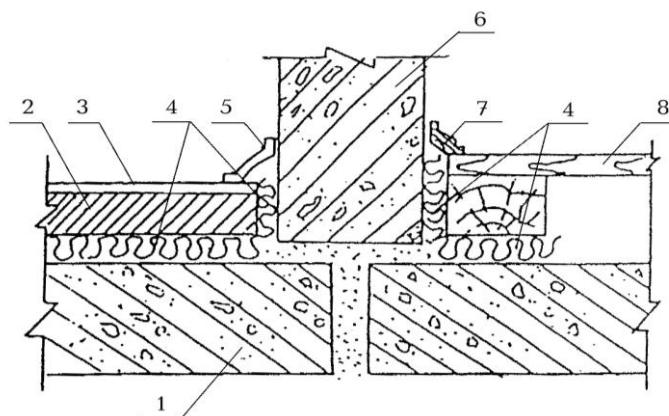
1 — несущая часть междуетажного перекрытия; 2 — бетонное основание пола; 3 — покрытие пола; 4 — прокладка (слой) из звукоизоляционного материала; 5 — гибкий пластмассовый плинтус; 6 — стена; 7 — деревянная галтель; 8 — дощатый пол на лагах
