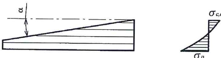
Рисунок 23 – Односкатная балка
