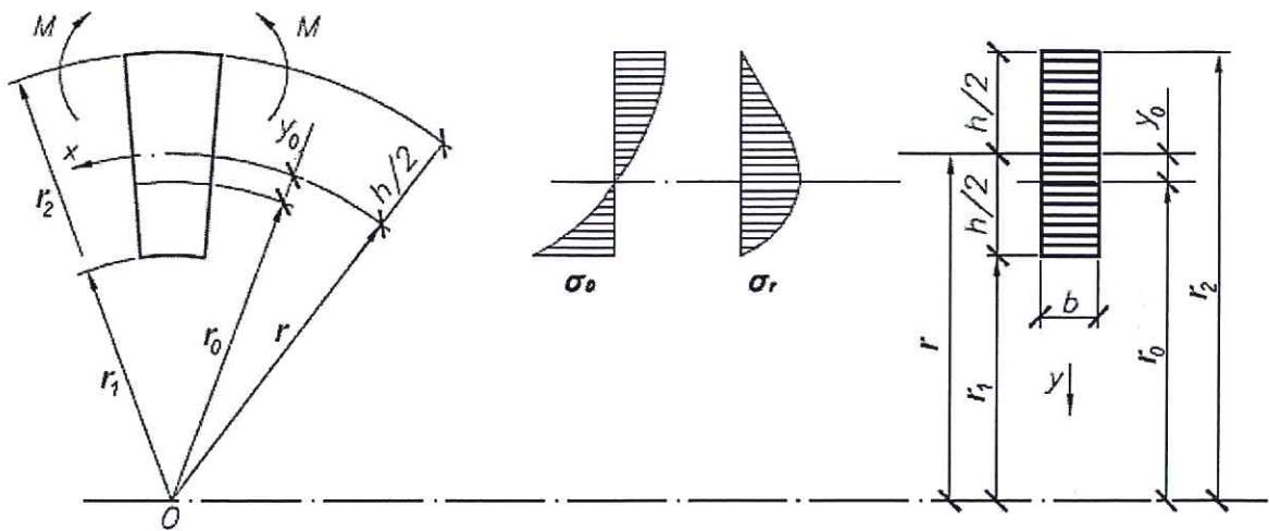
**Рисунок 3 – Расчетная схема кривого бруса при чистом изгибе**
