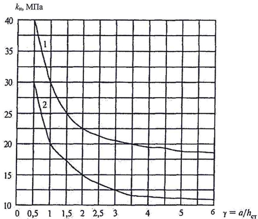
1 – для бакелизированной фанеры марок ФБС и ФБСВ толщиной 7 мм и более; 2 – для березовой фанеры марки ФСБ толщиной 8 мм и более. В выражении  $\gamma = a/h_{ct}$   $a$  – расстояние между ребрами жесткости балки;  $h_{ct}$  – высота стенки между внутренними гранями полок
