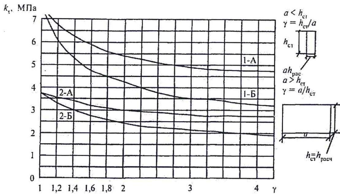
1-*A* – для бакелизированной фанеры марок ФБС и ФБСВ толщиной 7 мм и более при направлении волокон наружных слоев параллельно малой стороне панели; 1-*Б* – для бакелизированной фанеры марок ФБС и ФБСВ толщиной 7 мм и более при направлении волокон наружных слоев перпендикулярно малой стороне панели; 2-*A*, 2-*Б* – то же, для березовой фанеры марки ФСФ толщиной 8 мм и более
