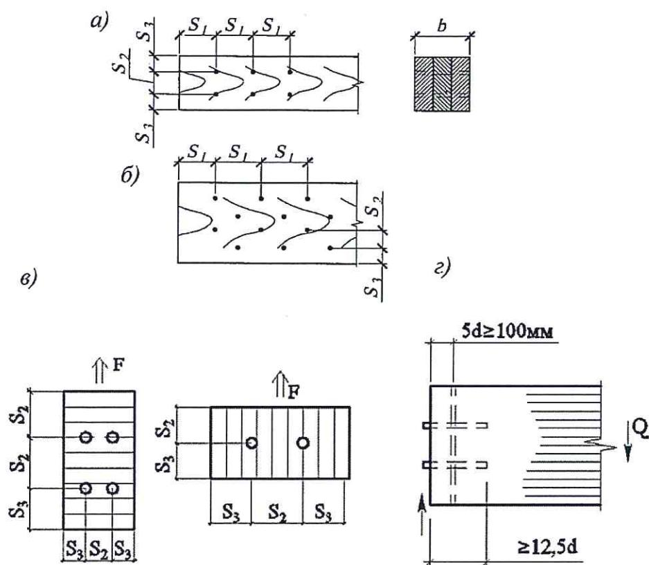
*a – прямая; б – в шахматном порядке; в – установленных в торец без армирования; г – то же, с усилением армированием*
