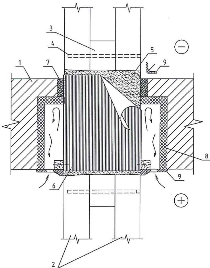
1 – наружная стена; 2 – спаренная несущая КДК; 3 – вставка; 4 – вклеенный металлический стержень; 5 – поверхность, обработанная антисептиком; 6 – влагозоляционный бандаж; 7 – монтажная пена; 8 – плитный утеплитель; 9 – нащельник
