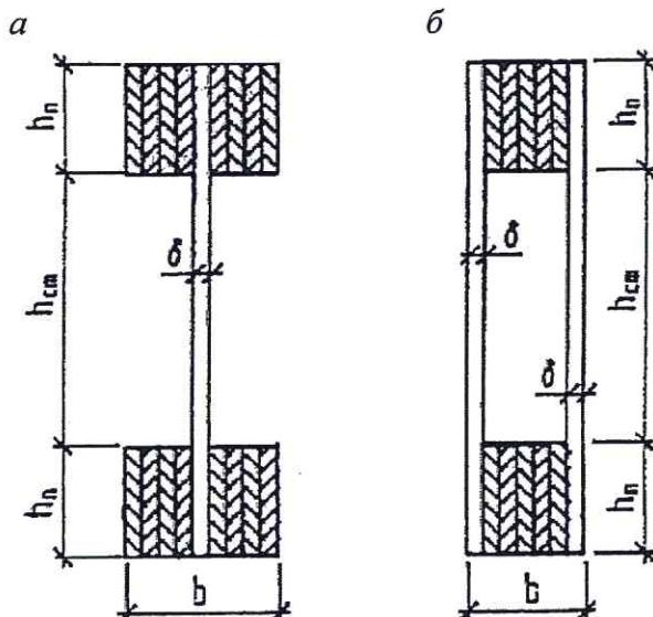
а – двутаврового сечения; б – коробчатого сечения
