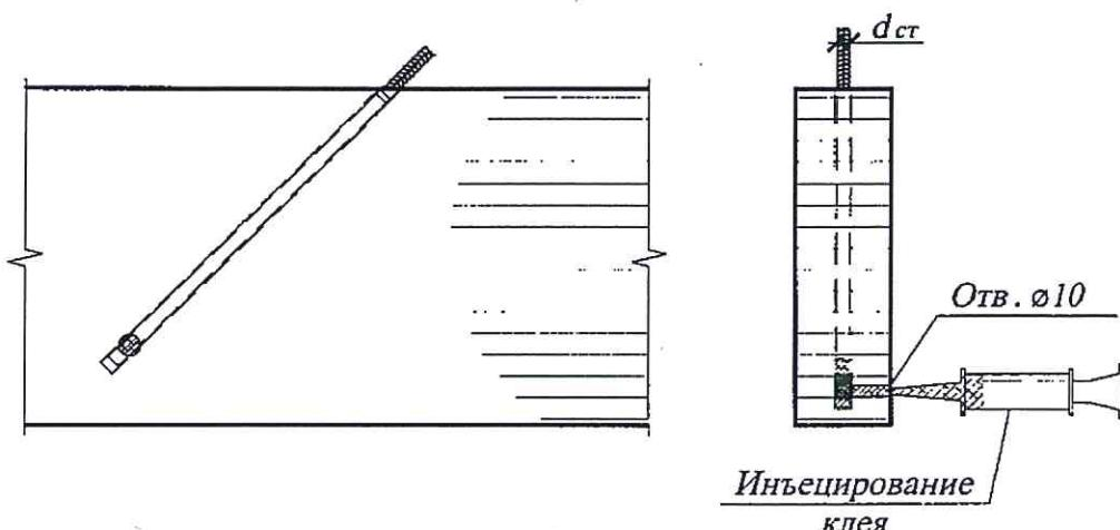
**Рисунок Ж.2 – Схема подачи клея под давлением**
