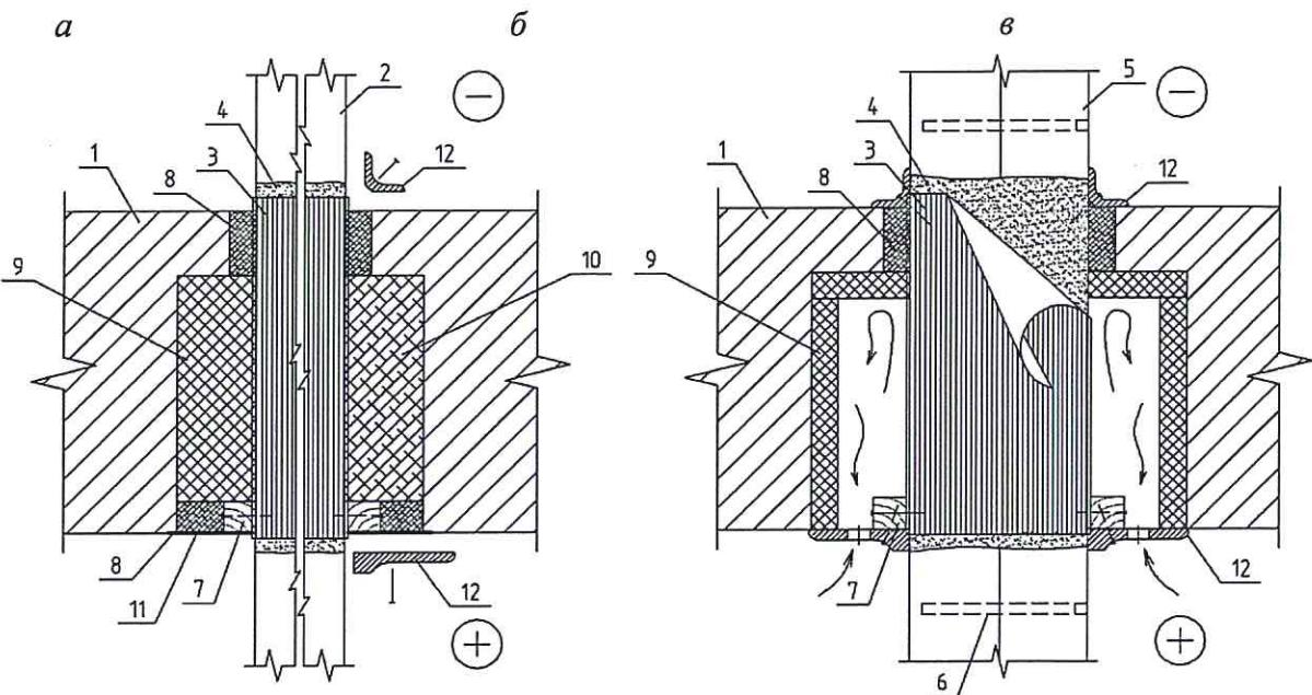
*a – с утеплением зазоров плитным утеплителем; б – то же, заливочным пенополиуретаном (ППУ);
