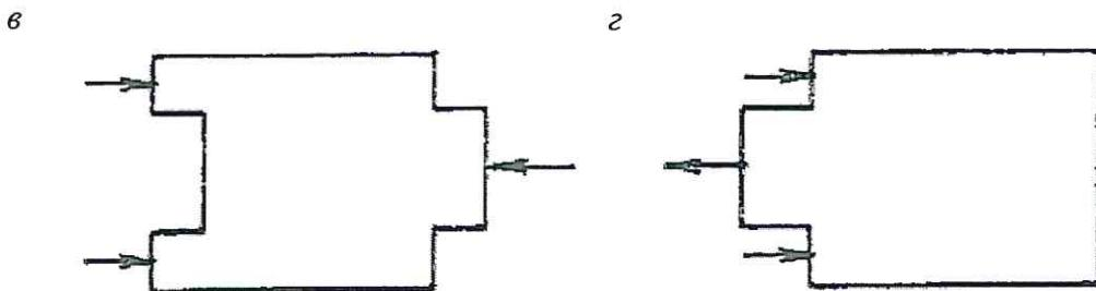
*а – несимметричная; б – симметричная; в, г – схемы скальвания в соединениях*
