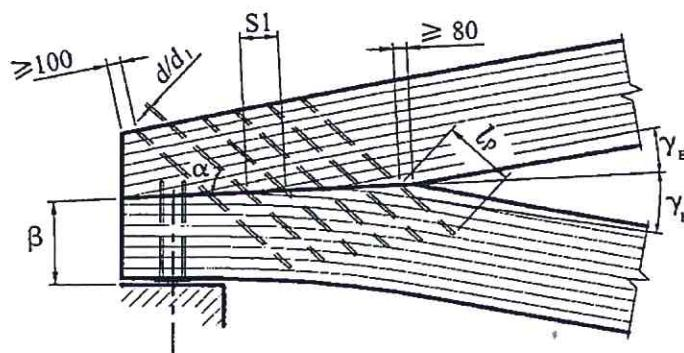
*Рисунок М.1 – Схема опорного узла линзообразной фермы*
