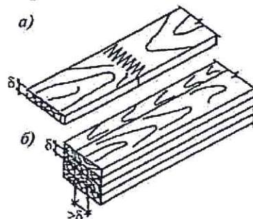
*а – при стыковании отдельных слоев по длине зубчатым шипом, выходящим на пласт;*
