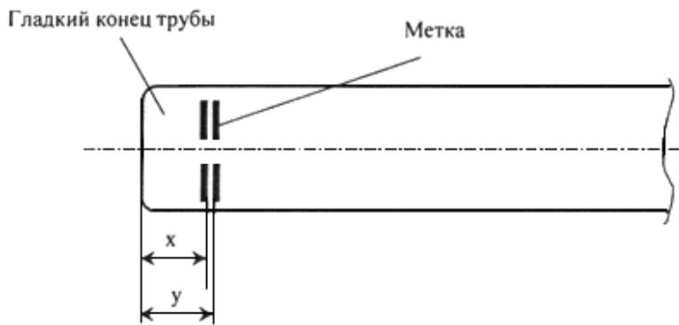
Рисунок 5.8 - Нанесение меток. Метка  $y$  равна глубине раstruba, а  $x = y - 10$  мм, для всех диаметров труб
