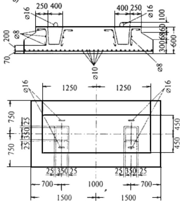
**Рисунок 6.5 - Опорные железобетонные башмаки для труб диаметрами 400-500 мм под одну**
