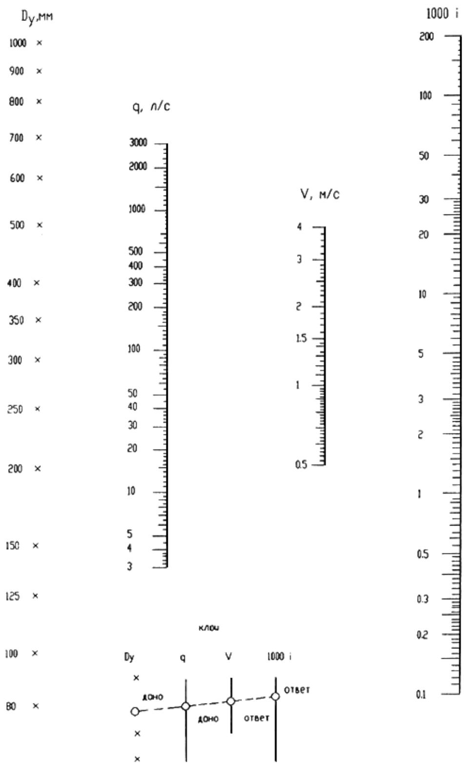
$D_y$  - диаметр условного прохода;  $q$  - расчетный расход воды;  $V$  - средняя скорость движения воды (сточной воды);  $i$  - гидравлический уклон
