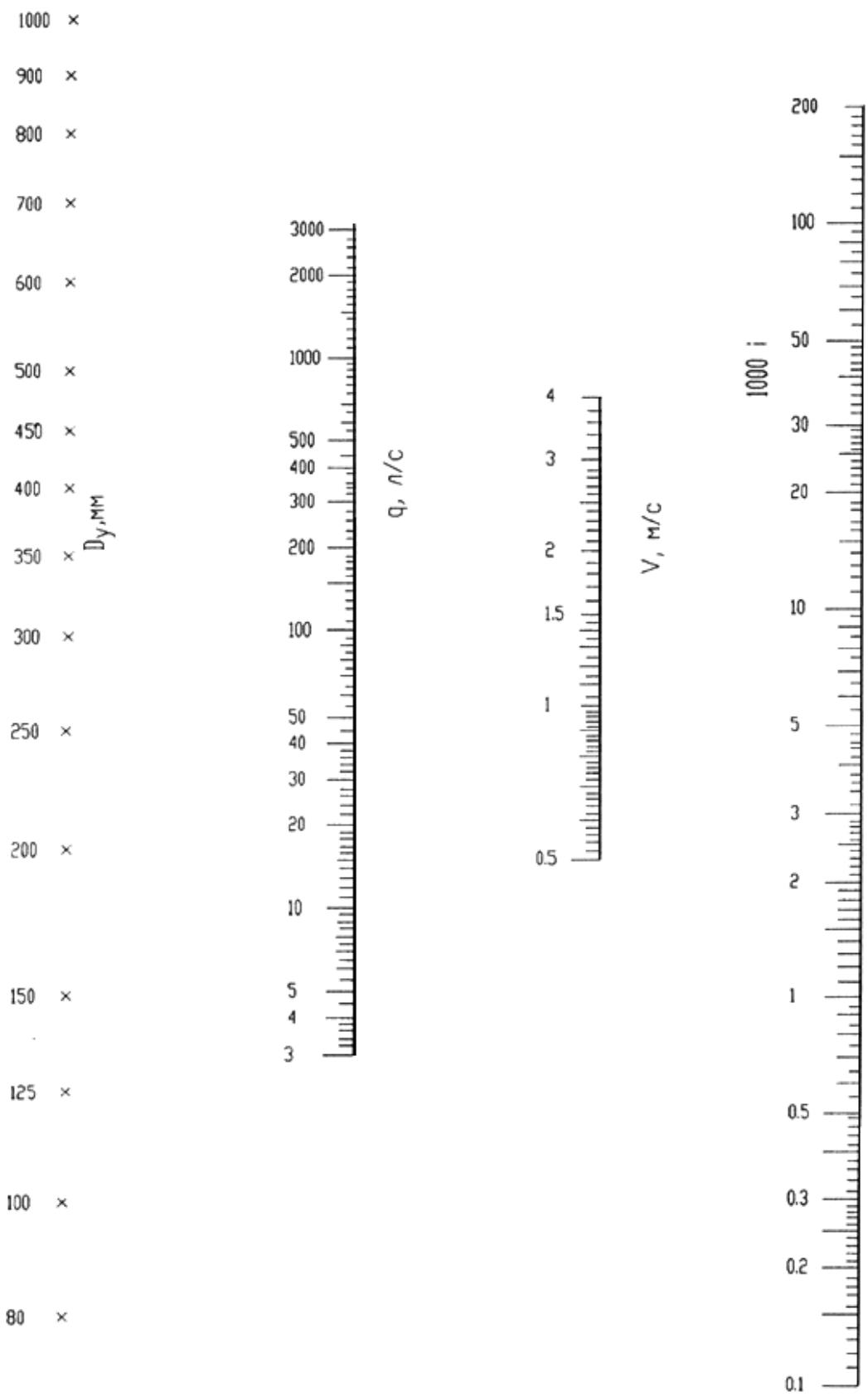
**Рисунок 5.4 - Номограмма для приближенных гидравлических расчетов напорных трубопроводов из высокопрочных труб из чугуна с шаровидным графитом класса К-9 с полимерным покрытием**
