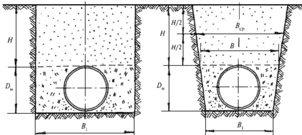
5.3.2 Грунты засыпки условно подразделяются на шесть категорий. Нормативные значения удельного веса  $\gamma$  и модуля деформации  $E_{\text{тр}}$  грунтов засыпки приведены в таблице 5.5.
