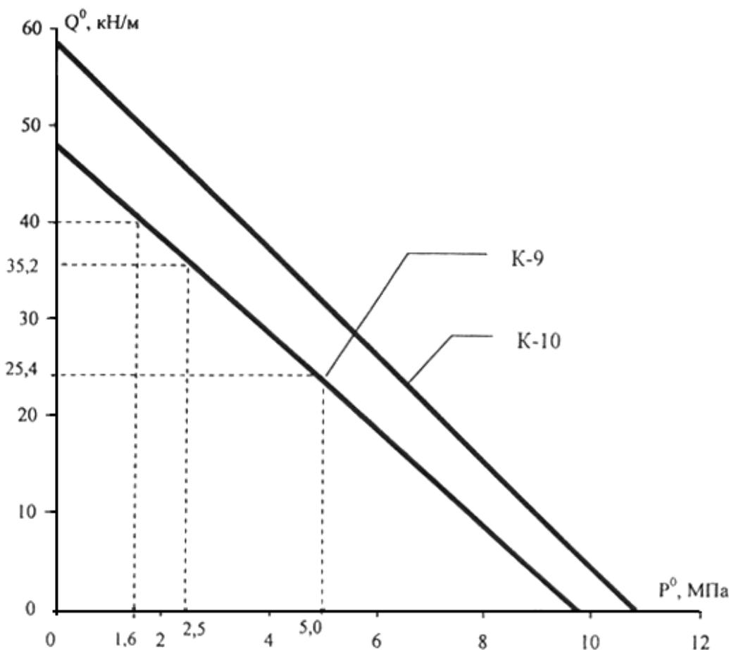
5.8.6 Графики являются линиями равной прочности при любых сочетаниях нагрузок, когда суммарные напряжения в стенках трубы не превышают  $R_p = 300$  МПа от воздействия внешних нагрузок и внутреннего давления при любых сочетаниях. Пояснения по использованию графика (рисунок 5.6) приведены в примере расчета в разделе 5.10.
