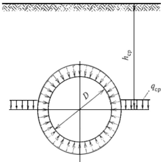
Для расчета принимается среднее давление грунта по горизонтальной плоскости, проходящей через центр трубопровода, которое определяется по формуле
