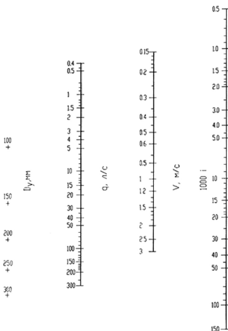
**Рисунок 5.2 - Номограмма для приближенных гидравлических расчетов напорных трубопроводов диаметрами 350-1000 мм из высокопрочных труб из чугуна с шаровидным графитом класса К-9 с внутренним цементно-песчаным покрытием**
