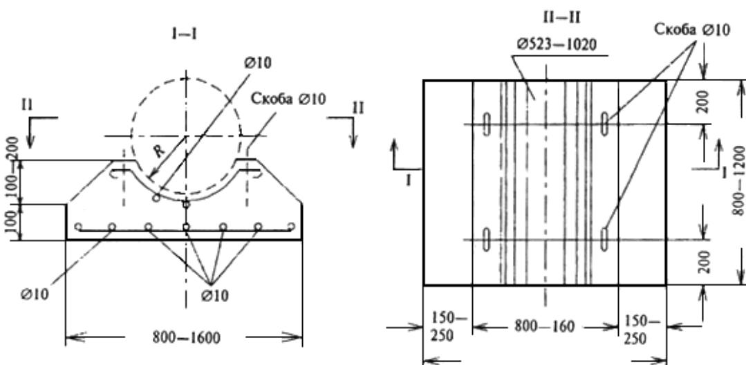
6.10.3 Плитные опоры и стойки рекомендуется изготавливать из бетона класса В15, морозостойкостью F300 и водонепроницаемостью W4.
