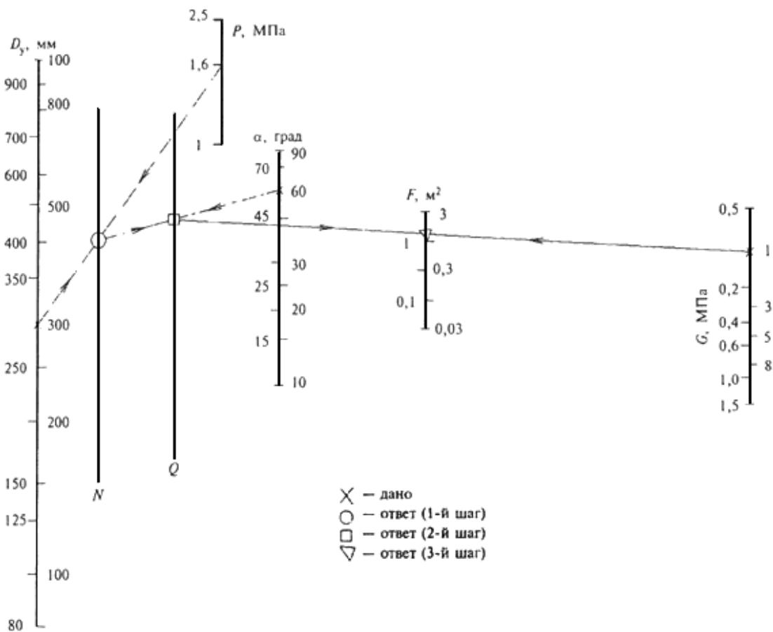
Рисунок 5.10 - Номограмма для выбора опорной площади упоров  $F$  на напорном трубопроводе условным диаметром  $D_y$  из труб из высокопрочного чугуна с шаровидным графитом с раструбными соединениями, находящемся под внутренним давлением  $P$ , при угле поворота трассы  $\alpha$  с опорой на грунт прочностью  $G$  ( $N$  и  $Q$  - промежуточные шкалы)
