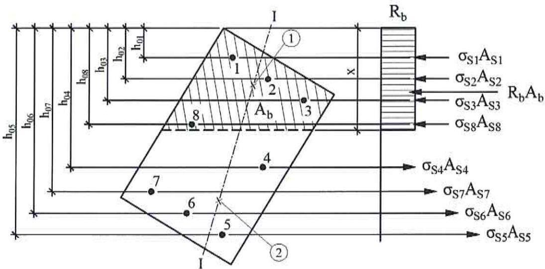
I-I – плоскость, параллельная плоскости действия изгибающего момента, или плоскость, проходящая через точки приложения нормальной силы и равнодействующих внутренних сжимающих и растягивающих усилий;
