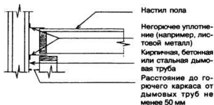
Рисунок 13-3 — Расстояние от дымовой трубы до строительных конструкций
