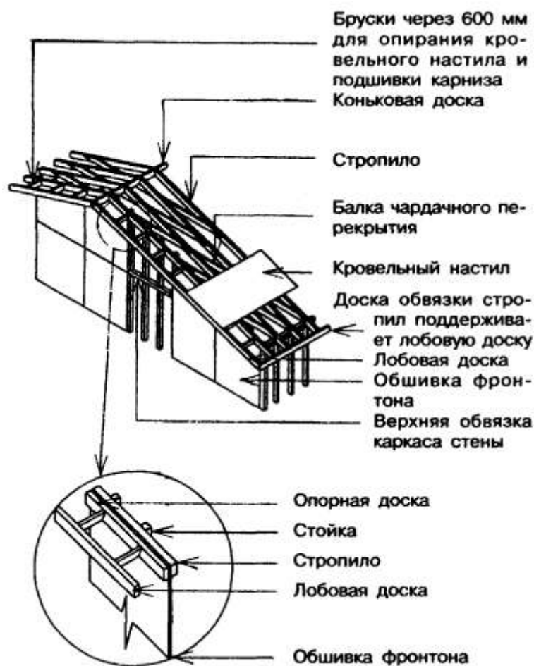
Рисунок 8-6 — Карниз над фронтоном с выносом 300 мм и менее
