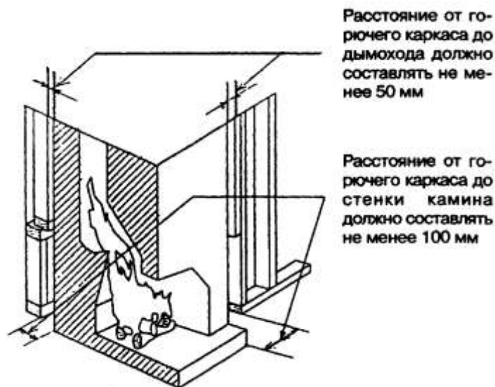
Рисунок 13-2 — Расстояние от стенок камина до каркаса здания
