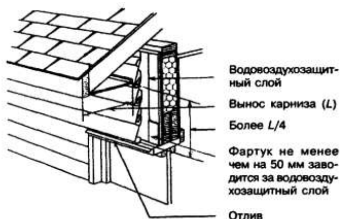
Рисунок 10-4 — Фартук над оконным (дверным) проемом
