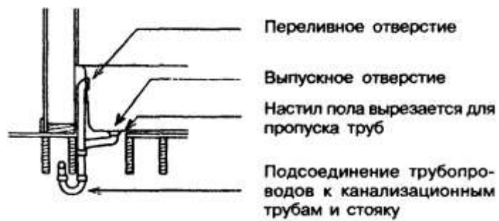
Рисунок 13-6 — Детали установки умывальника и ванны
