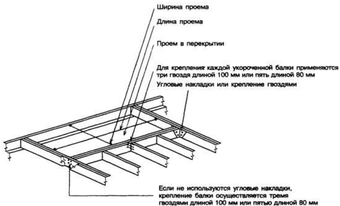
Рисунок 6-11 — Устройство консолей
