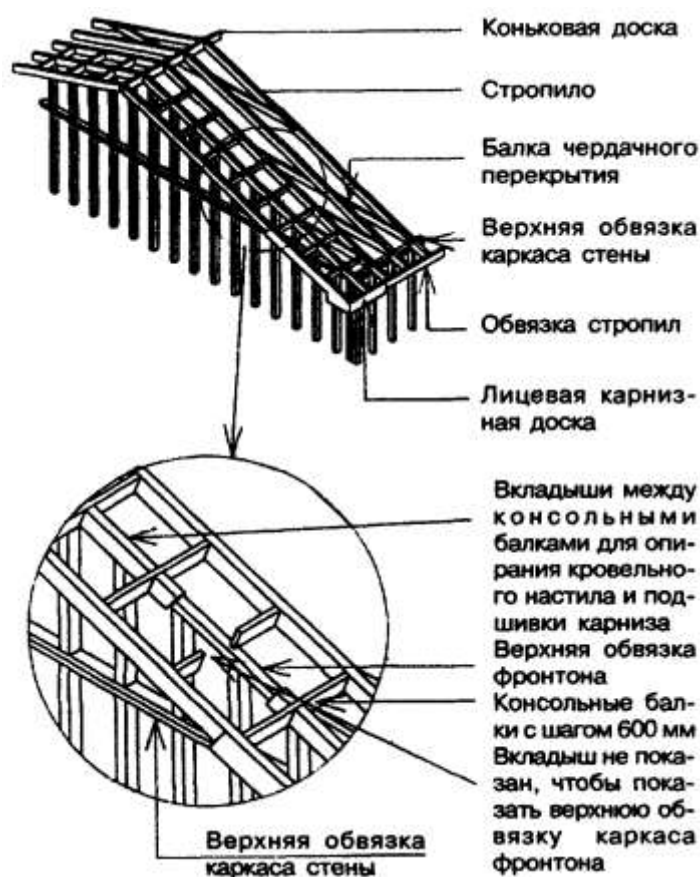
Рисунок 8-7 — Карниз над фронтоном с выносом более 300 мм
