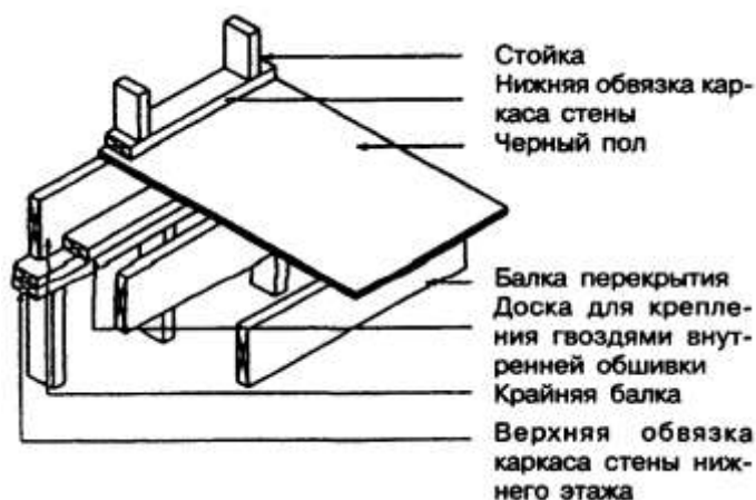
Рисунок 7-4 — Деталь установки доски для крепления внутренней обшивки
