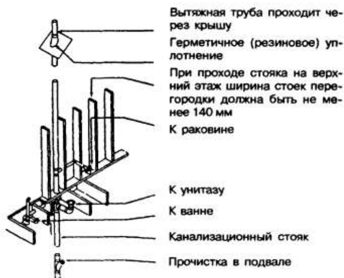
Рисунок 13-8 — Прокладка канализационных труб в каркасе дома
