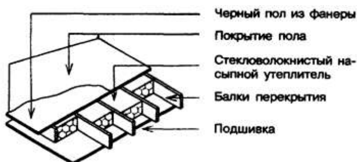
Рисунок 9-3 — Утепление перекрытий над неотапливаемыми помещениями
