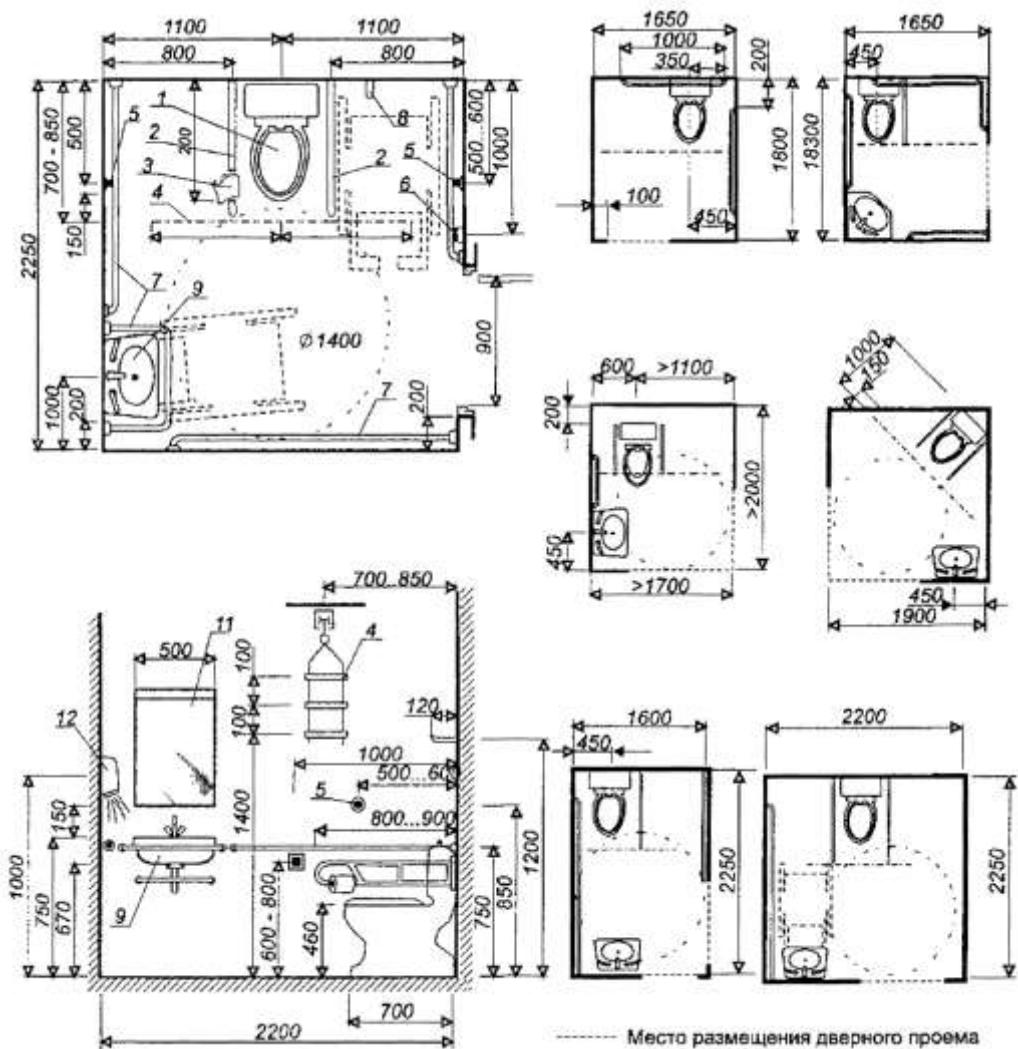
1 - унитаз; 2 - откидывающаяся опора для рук; 3 - бумагодержатель; 4 - штанга с навесными рукоятками; 5 - кнопка слива воды; 6 - кнопка сигнализации; 7 - горизонтальный поручень; 8 - крючок для одежды; 9 - раковина с туалетной полкой; 10 - рычажовый удлинитель крана; 11 - зеркало; 12 - фен
