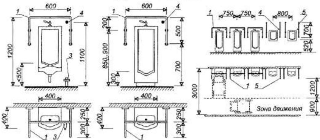
1 - поручни опоры; 2 - смыивной кран (ручной); 3 - смыивной кран (ножной);
