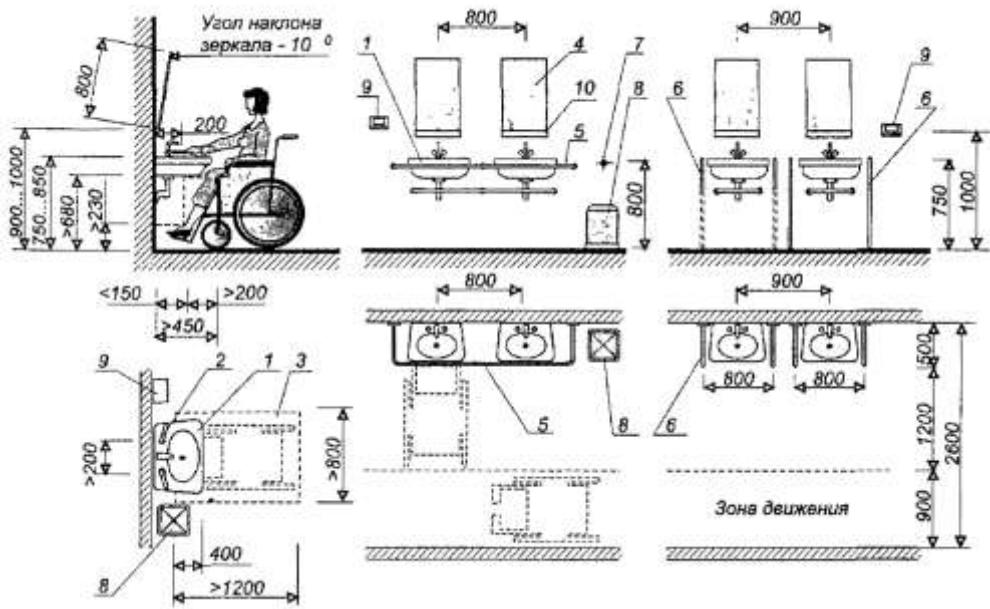
1 - раковина умывальника; 2 - рычаги управления кранами (вариант); 3 - зона кресла-коляски;
