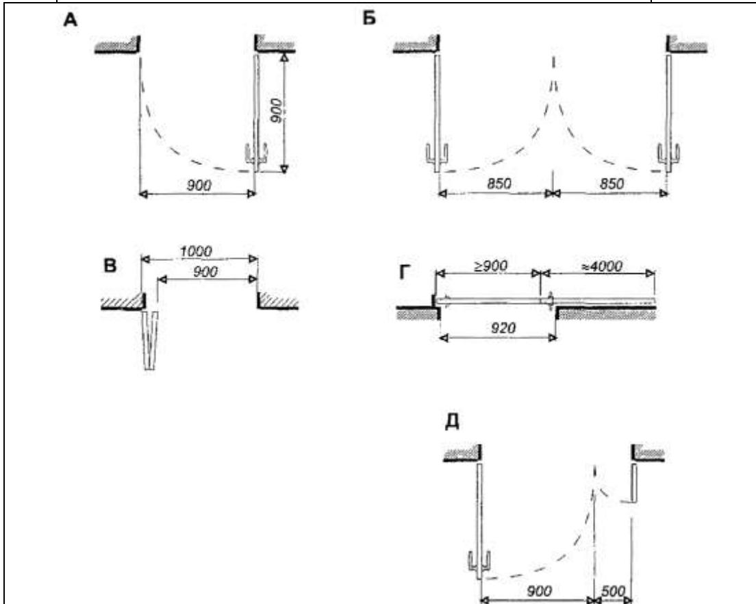
Ширина дверного просвета при различных видах дверей:
