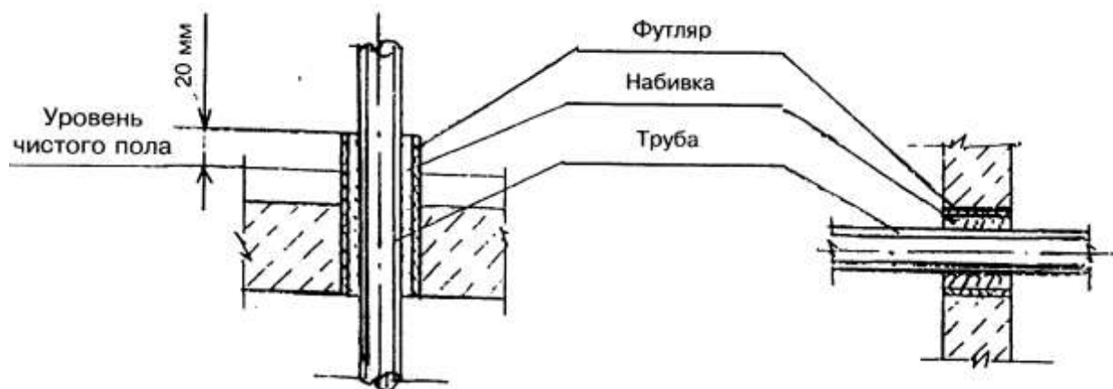
Рисунок 6 — Установка футляров для прохода труб через перекрытия, стены и перегородки
