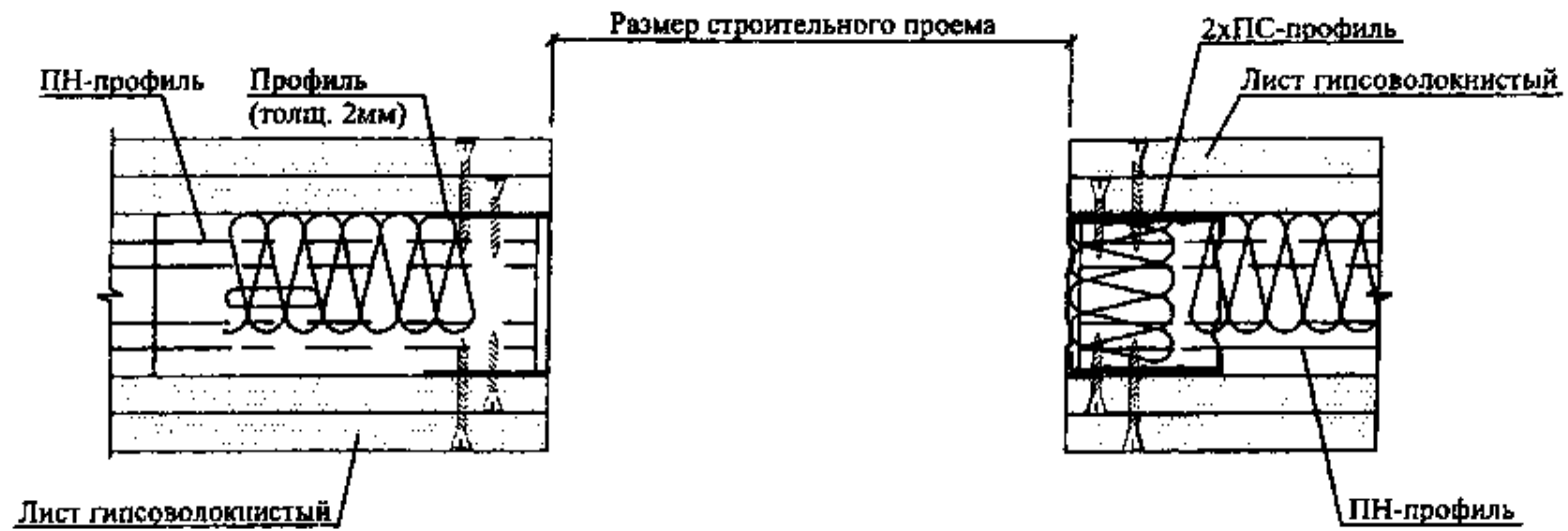
Рисунок 4 — Температурные швы и варианты дверных проемов в перегородках
